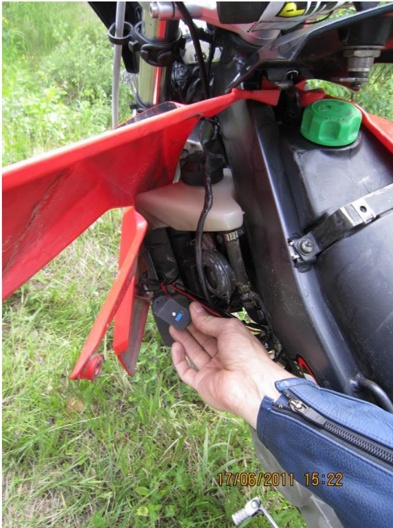
kuva 3: Esimerkki nappirajoittimen sijainnista mopon etukatteen alla. (kuva: Lounais-Suomen poliisilaitoksen Facebook)
