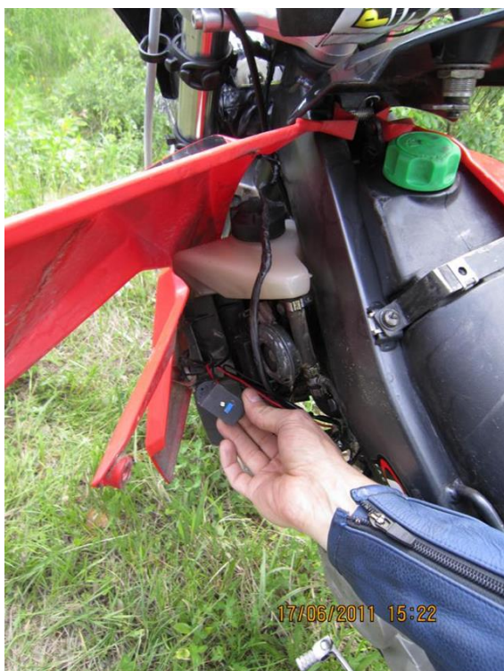
Mopon etukatteeseen piilotettu rajoitin
