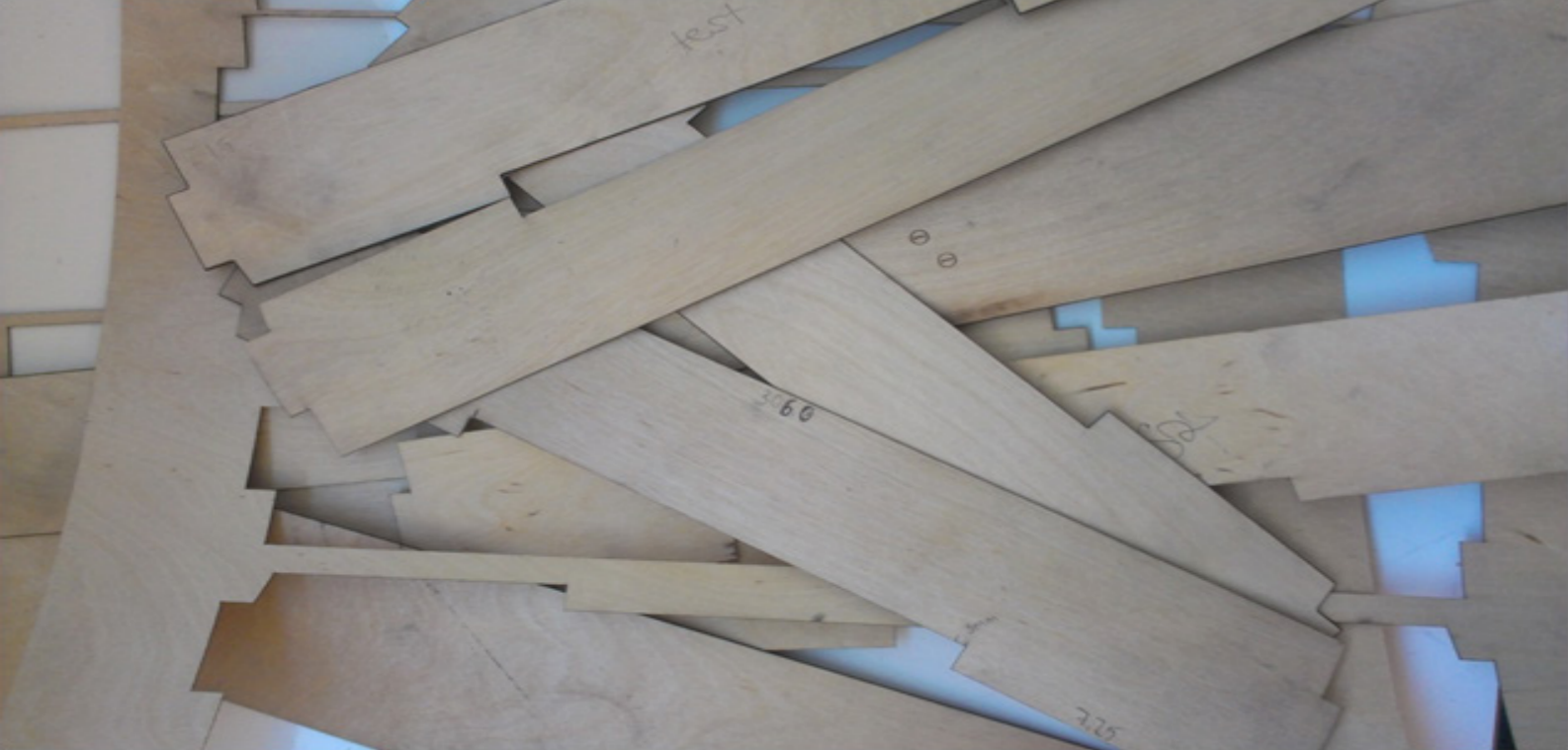
Kuva 14. Prototyppoinnissa käytettyjen 0,8 mm:n paksuisia koivuviilupaloja
