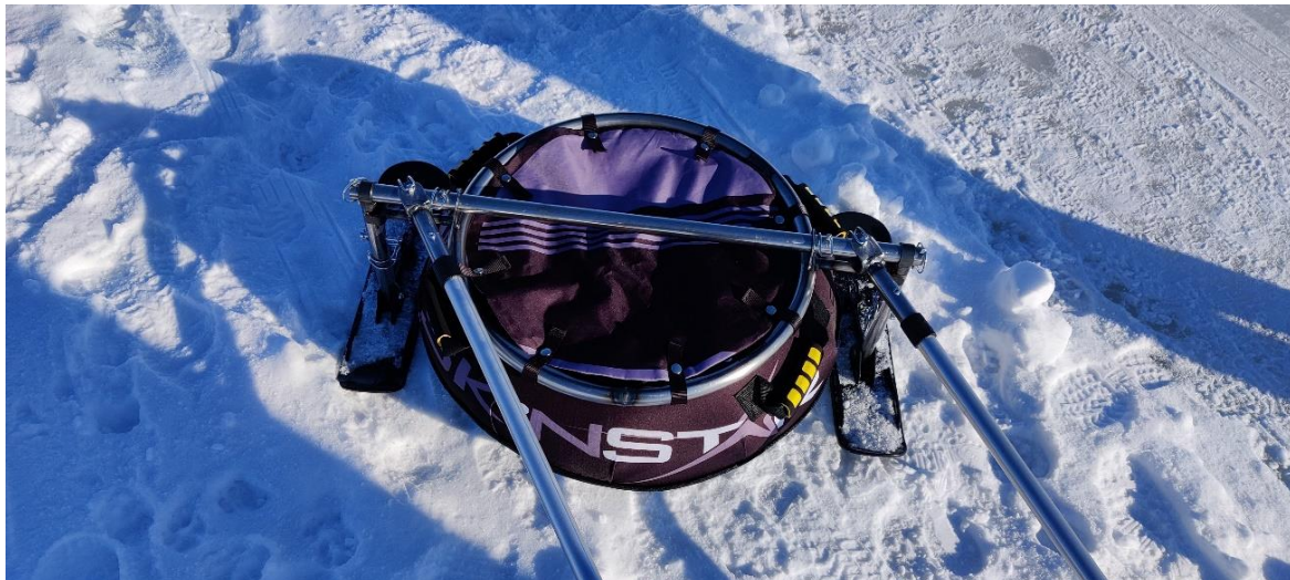
KUVA 17. @ Aki Volanen. Kuljetusalustaa voidaan kääntää helposti putkituppien nivelien avulla
