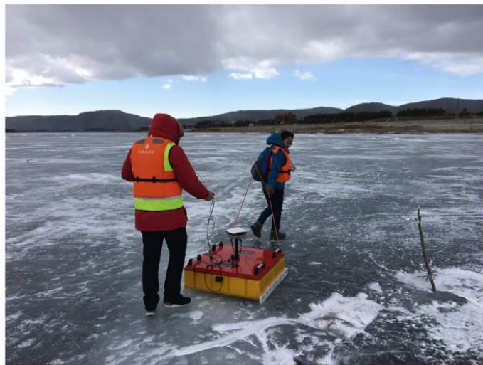
KUVA 6. Jään paksuuden mittauksia impulssitutkalla Heilongjiang joella Kiinassa [2, s. 87]
