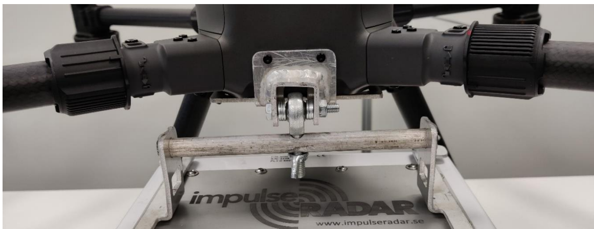
KUVA 22. @ Aki Volanen. Dronen teline ja impulssitutkan telakka
