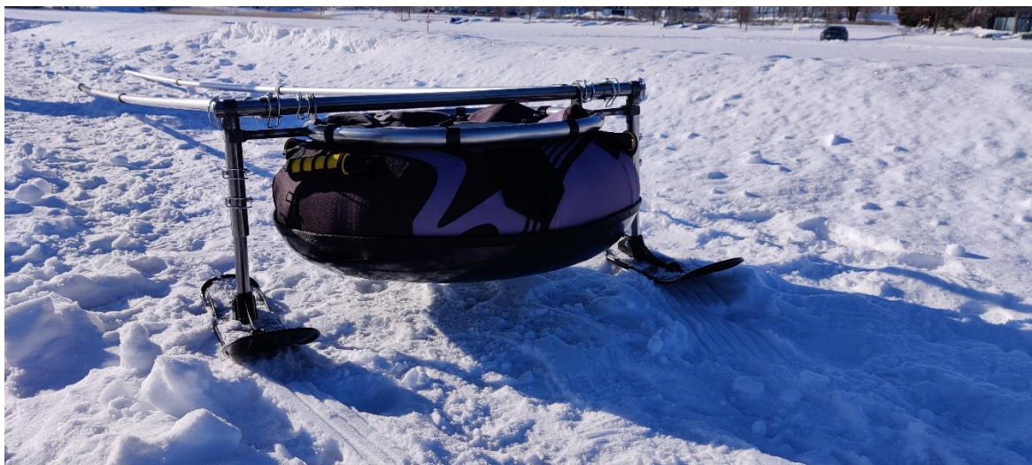
KUVA 18. @ Aki Volanen. Kuljetusalustan korkeutta voidaan nostaa suksien jaloista
