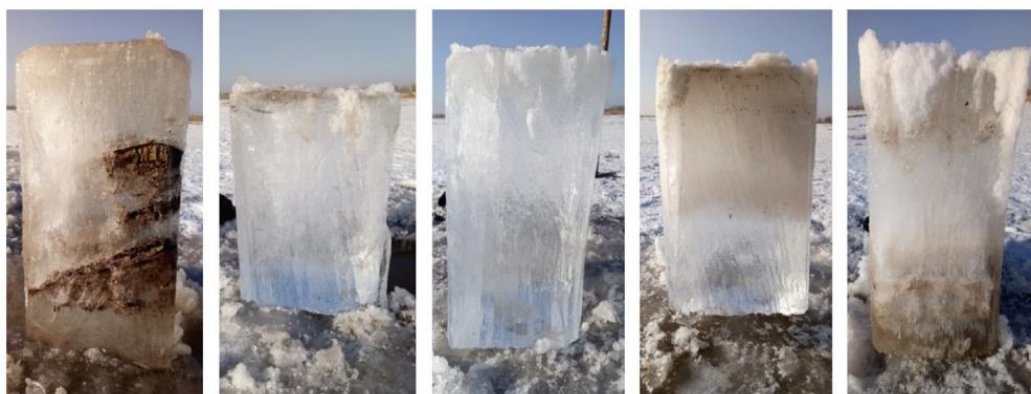
KUVA 4. Eri materiaalien sekoittuminen toisiinsa on nähtävissä jäädä otetuista näytteistä [2, s. 91]
