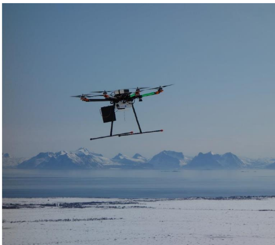
KUVA 7. @ Torgeir Vaa. Impulssitutkaa voidaan kuljettaa myös dronella [3, s. 15]
