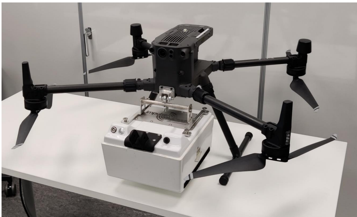
KUVA 21. @ Aki Volanen. Impulssitutka kiinnitettynä droneen
