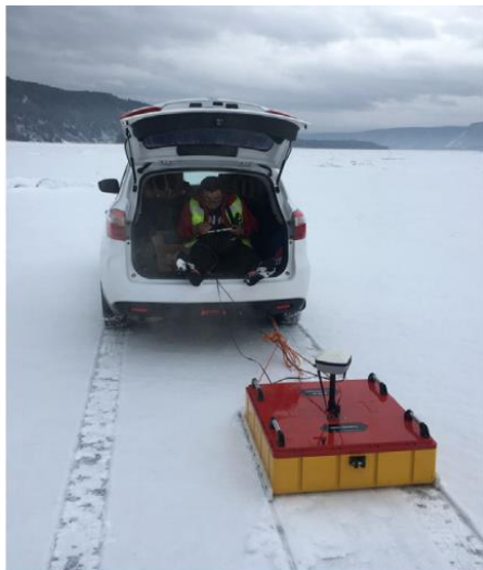
KUVA 6. Jään paksuuden mittauksia impulssitutkalla Heilongjiang joella Kiinassa [2, s. 87]
