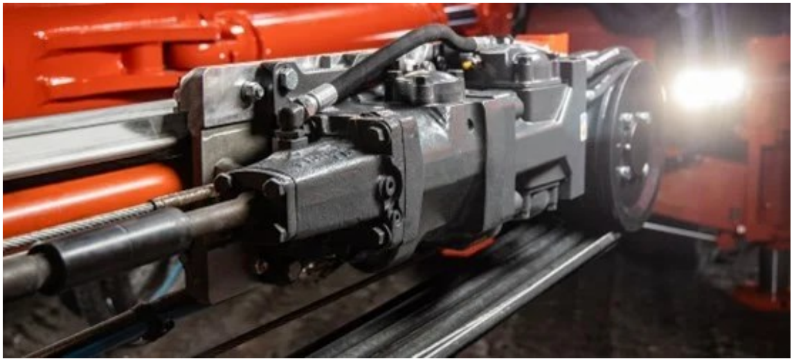
Kuvio 5. RD535 paikoillaan syöttölaitteessa (Sandvik Mining and Construction 2022d)
