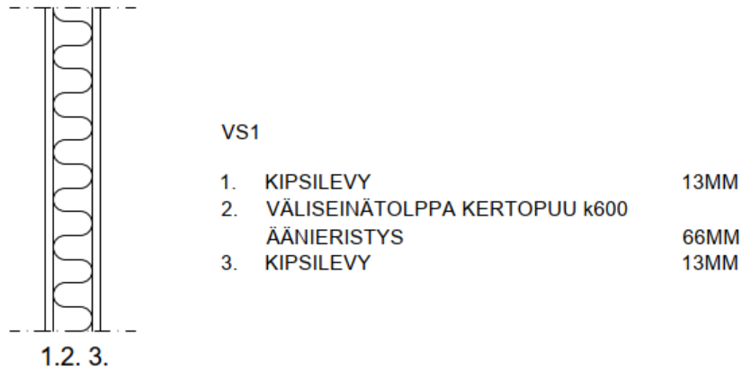
Kuva 12. VS1 rakenne
