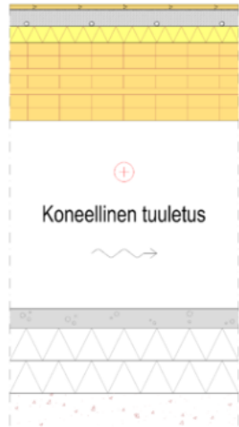
Kuva 20. Lämmin tuulettuva massiivipuinen alapohja (Puuinfo, 2020j).
