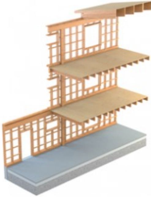
Kuva 3. Havainnekuva pilari-palkkijärjestelmällä toteutetusta kerrostalon rungosta. (Puuinfo, 2020d.)
