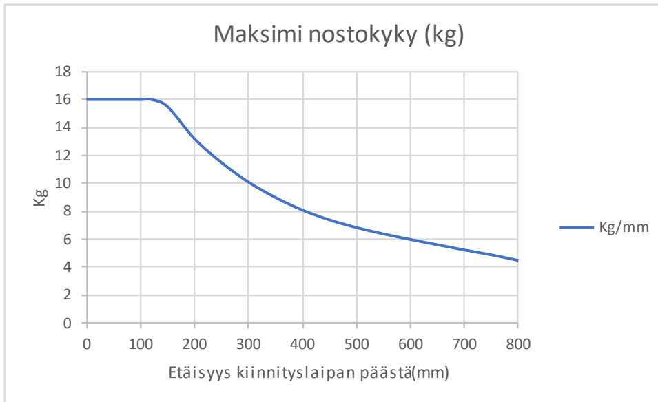
Kuvio 1. UR16e maksimi nostokyky, kun kappaleen painopiste siirtyy cobotin kiinnityslaipan päästä.
