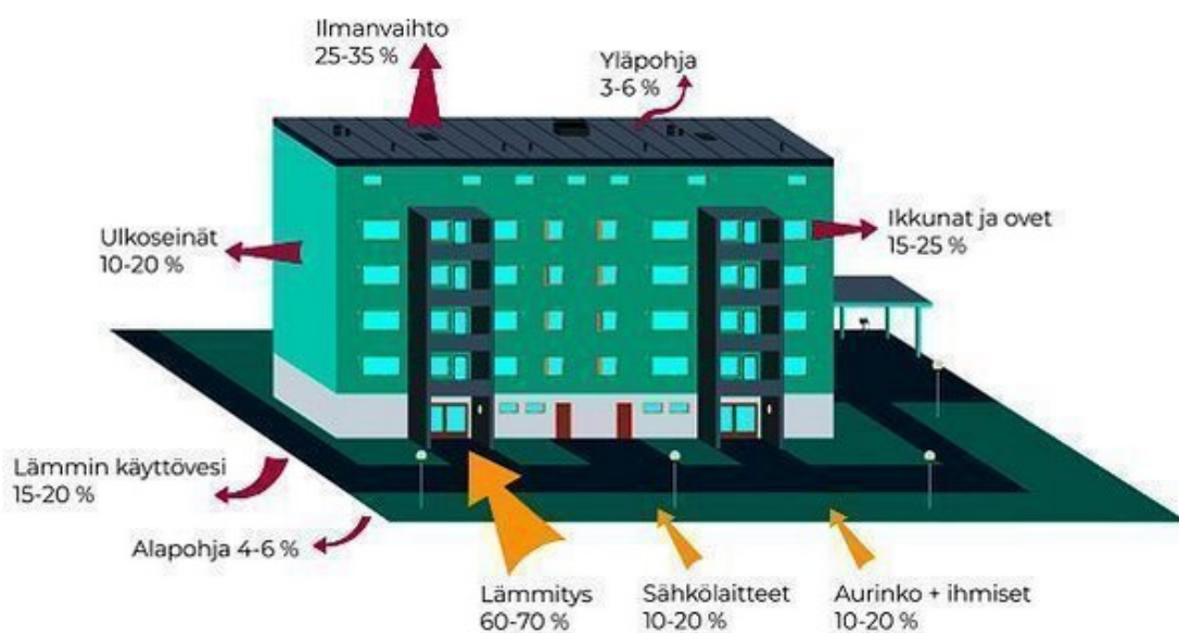
Kuva 1. Lämpöhäviöt ja lämmönlähteet 1960–1980-lukujen asuinkerrostaloissa. [6]
