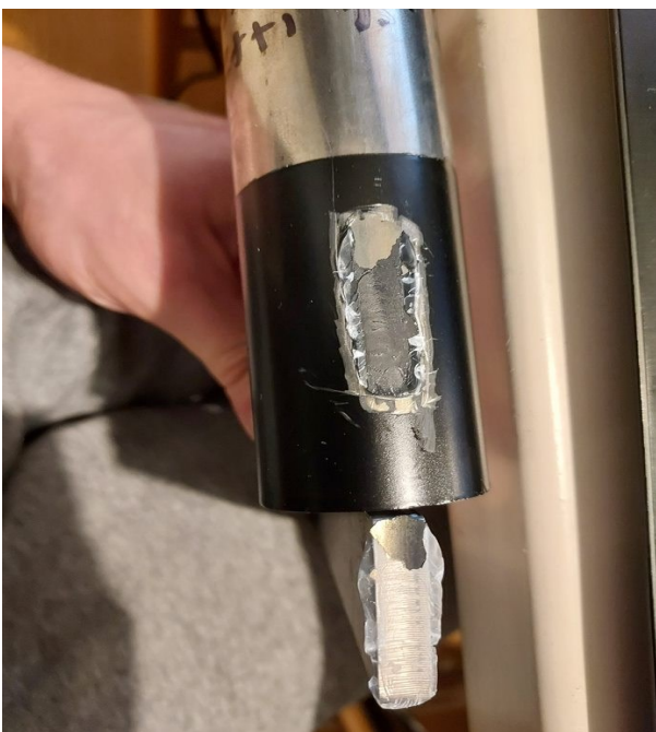
Kuva 18. Tartuntavetokokeessa irronnutta maalipintaa.
