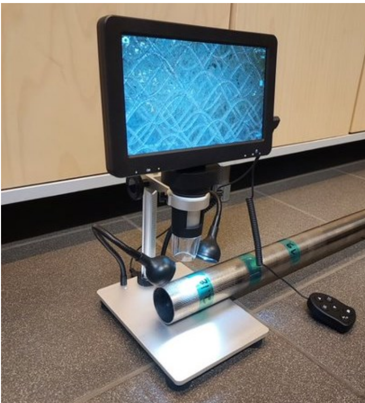
Kuva 7. Teräsputken pinnan tarkastelu Hayve 7” LCD-digitaalimikroskoopilla.
