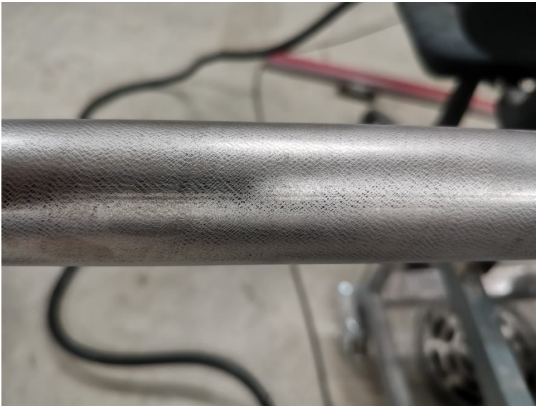
Kuva 5. Laserpuhdistuksen tuottaman mekaanisen esikäsittelyn jälki.
