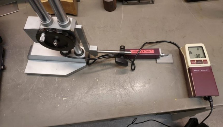
Kuva 6. Mitutoyo SJ-201 pinnankarheuden mittauslaitteisto.
