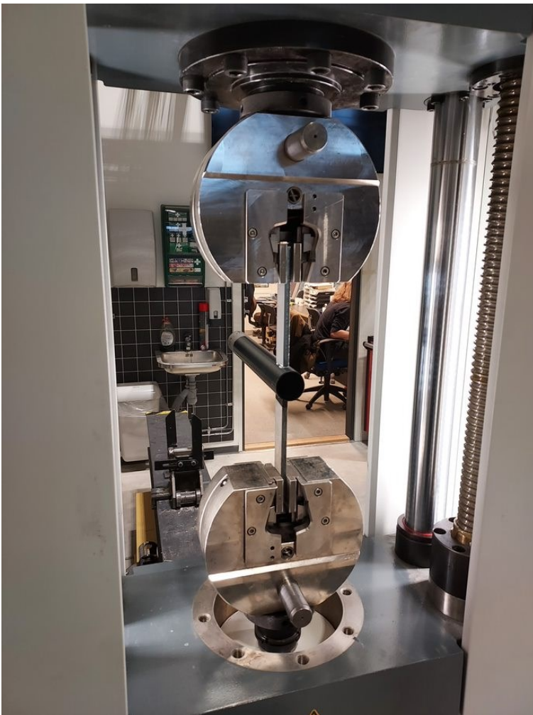
Kuva 15. Koekappale kiinnitettynä vetokoneeseen.
