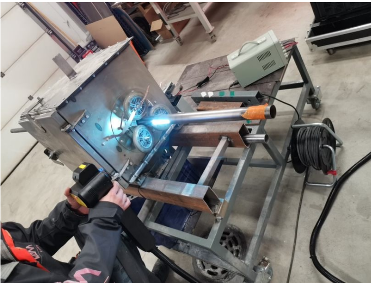
Kuva 4. Pyöreän putken pyöritys- ja syöttölaitteisto.
