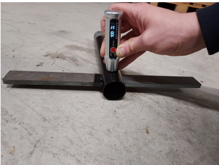
Kuva 17. Koekappaleen jauhemaalauksen kalvonpaksuusmittaus.
