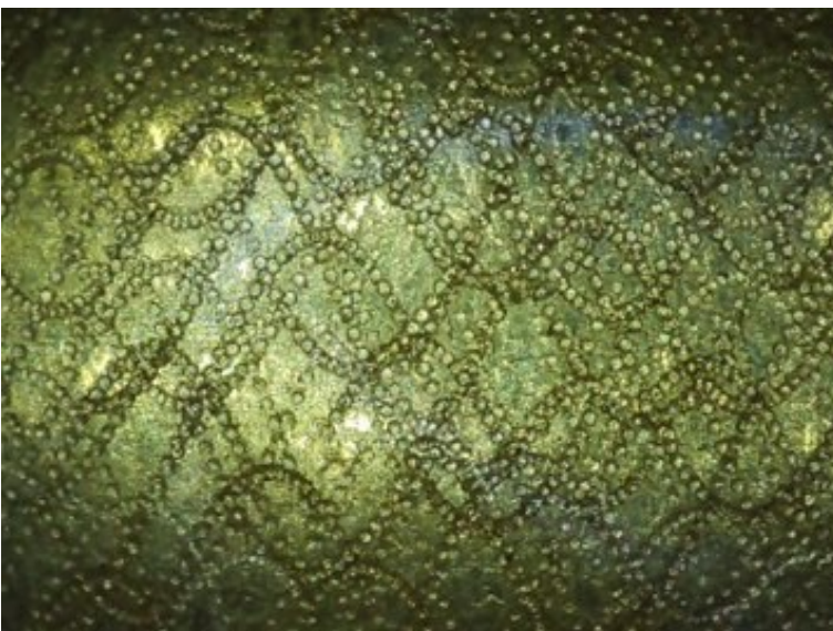
Kuva 11. W2MCF-120X MOPA 120W -pinnan mikroskooppikuva.
