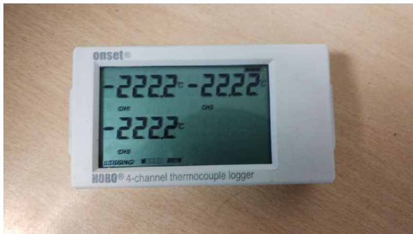
Kuva 6. Lämpötilamittauksissa käytetty dataloggeri
