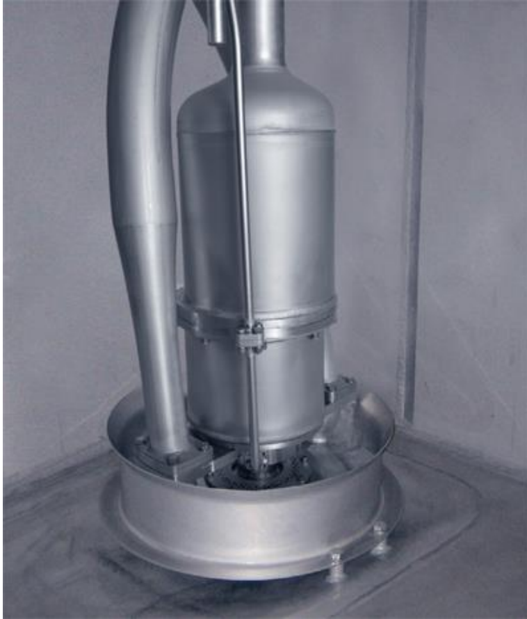
Kuva 7. Hydraulisesti toimiva lastipumppu (Framo 2014).
