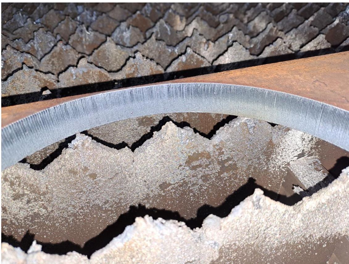
Kuva 6. Leikkuupinta 20 millimetrin S355 levyssä, Riku Kokko
