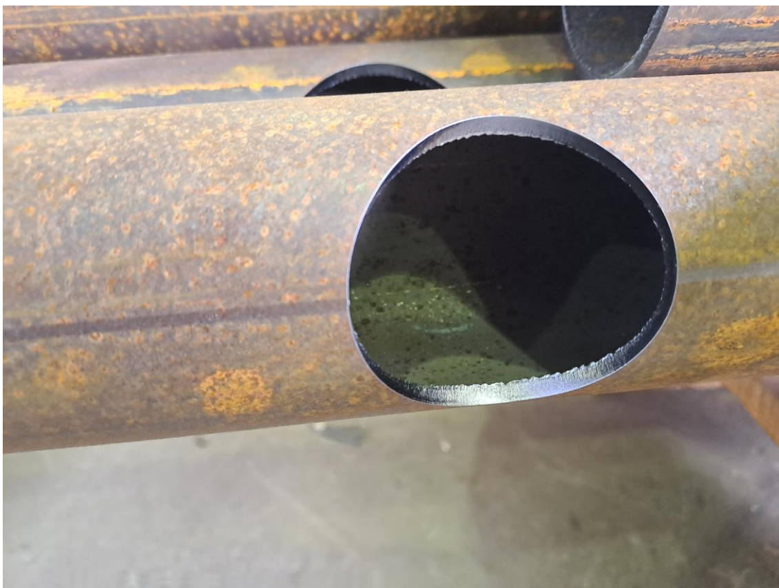
Kuva 5. Ø48,3 putken leikattu reikä paineilmaa käyttämällä, Riku Kokko
