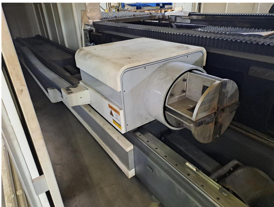
Kuva 7. Putkipuolen takapyörityspakka, Riku Kokko
