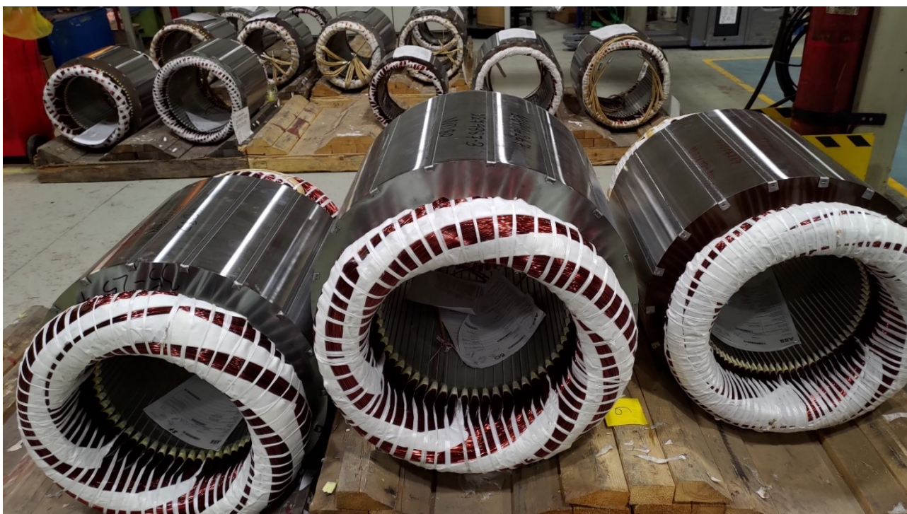
Kuva 1. Eri kokoisia staattoreita odottamassa hartsausta (Yritys, 2023).
