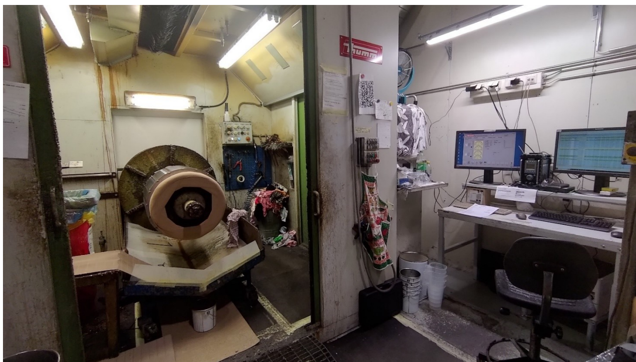
Kuva 2. Hartsauskone Thumm ja staattori valmiiksi kytkettynä hartsaamista varten (Yritys, 2022).
