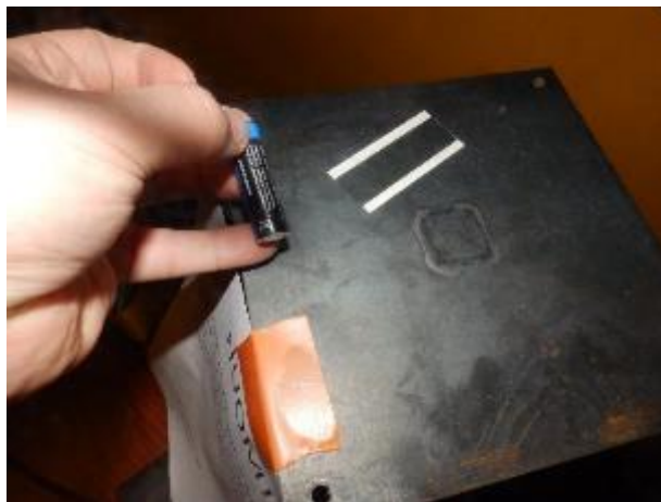
Kuva 77: Näytteet otettiin ohjeen mukaisesti käyttäen apuna pyöreäpintaista esinettä, jolla teipin tartunta alustaan varmistetaan.
