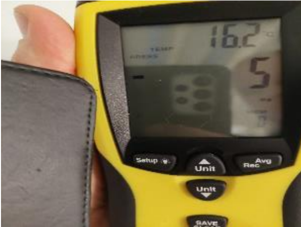
Kuva 75: Mitattiin paine-ero ulkovaipan yli -5 Pa, lämpökamera tarkastelun yhteydessä.
