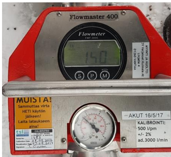
KUVA 16. Toinen mittaus. Vesivirtaama 150 litraa minuutissa, 8 baarin paineella (Tauriainen 2017, CC BY-SA)
