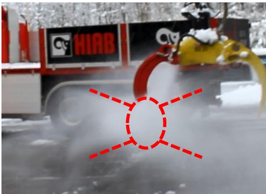
KUVA 8. SaRa-kouran suihkukuvio on suorakulmion muotoinen päädyistä 8 baari paineella (Tauriainen 2017, CC BY-SA)
