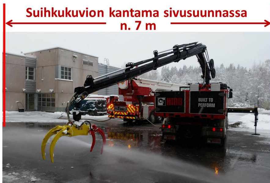
KUVA 11. SaRa-kouran vesisuihkun leveys on noin 7 metriä 8 baarin paineella (Tauriainen 2017, CC BY-SA)
