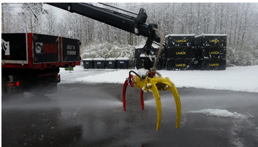
KUVA 3. SaRa-koura kytkettynä kuorma-auton kuormausnosturimeen ja on toiminnassa (Tauriainen 2017, CC BY-SA)
