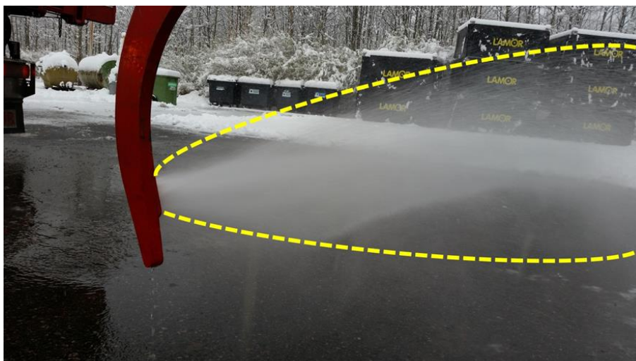
KUVA 12. SaRa-kouran suihkukuvio sivusta 8 baarin paineella (Tauriainen 2017, CC BY-SA)
