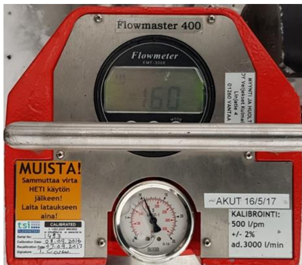
KUVA 17. Kolmas mittaus. Vesivirtaama 160 litraa minuutissa, 10 baarin paineella (Tauriainen 2017, CC BY-SA)
