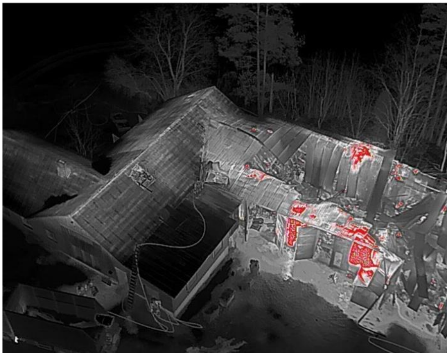
KUVA 18. UAS lämpökamerakuva rakennuspalosta, jossa punainen väri kuvastaa kuumimpia kohtia (Kymenlaakson pelastuslaitos 2023, CC BY-NC-SA)
