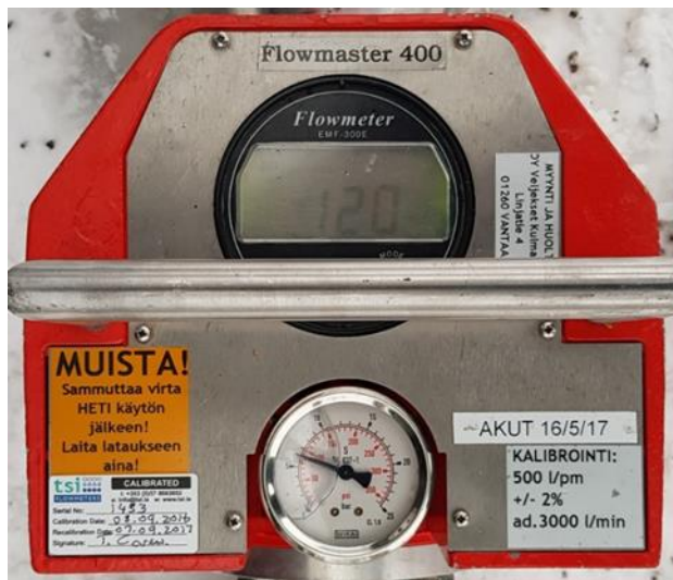
KUVA 15. Ensimmäinen mittaus. Vesivirtaama 120 litraa minuutissa, 6 baarin paineella (Tauriainen 2017, CC BY-SA)
