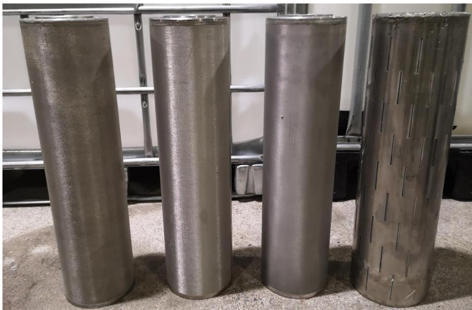
Kuva 16. Käytetyt elementit vasemmalta lukien 10, 5,1 \mu\text{m} suodattimet sekä ristivirtausputki.
