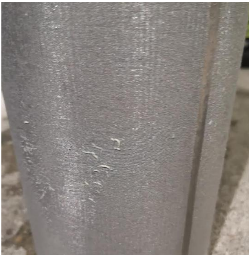
Kuva 24. 5 \mu m elementin pinnalle muodostunut kuituverkko.
