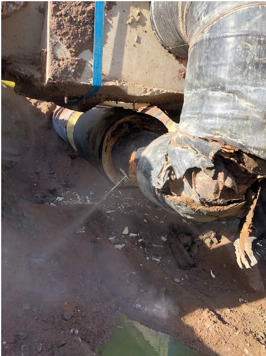
KUVA 9. Pistesyöpymä virtausputkessa. (Jalmari Tähtinen 2022)
