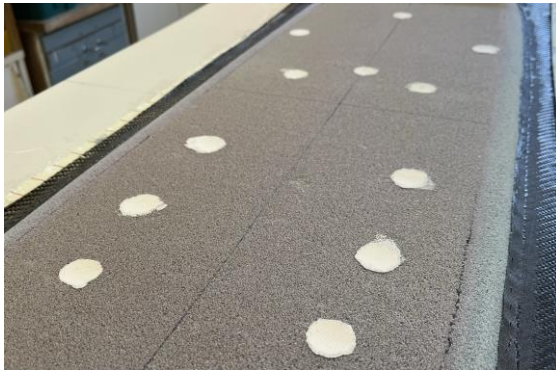
KUVA 19. Upotusmuttereiden kiinnitystä varten tehdyt vahvikkeet
