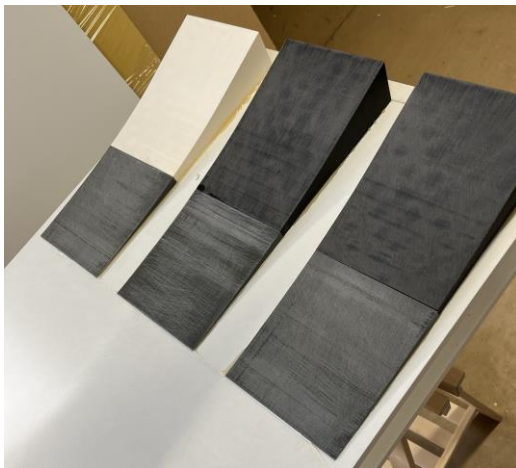
KUVA 7. Muottirunkoon kiinnitetyt 3D-tulostetut suksen toisen päädyn kaaripalat
