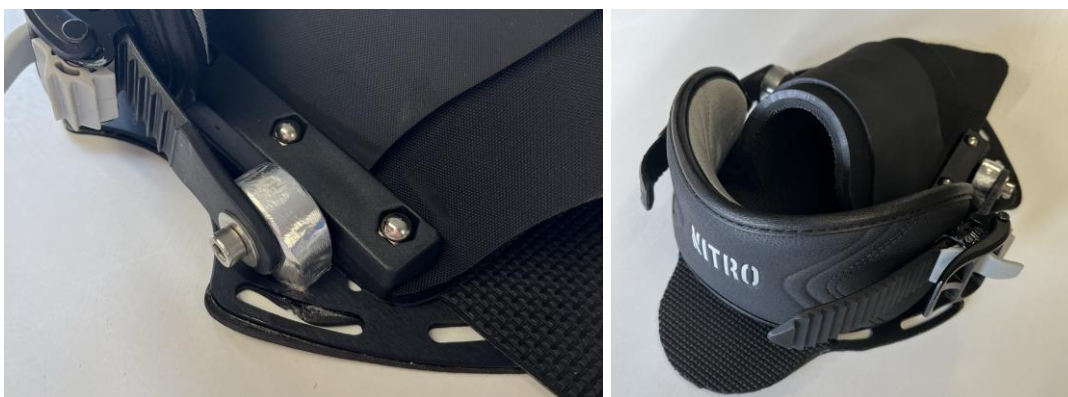
KUVA 26. Alumiinikiinnikkeet ja valmis takaside
