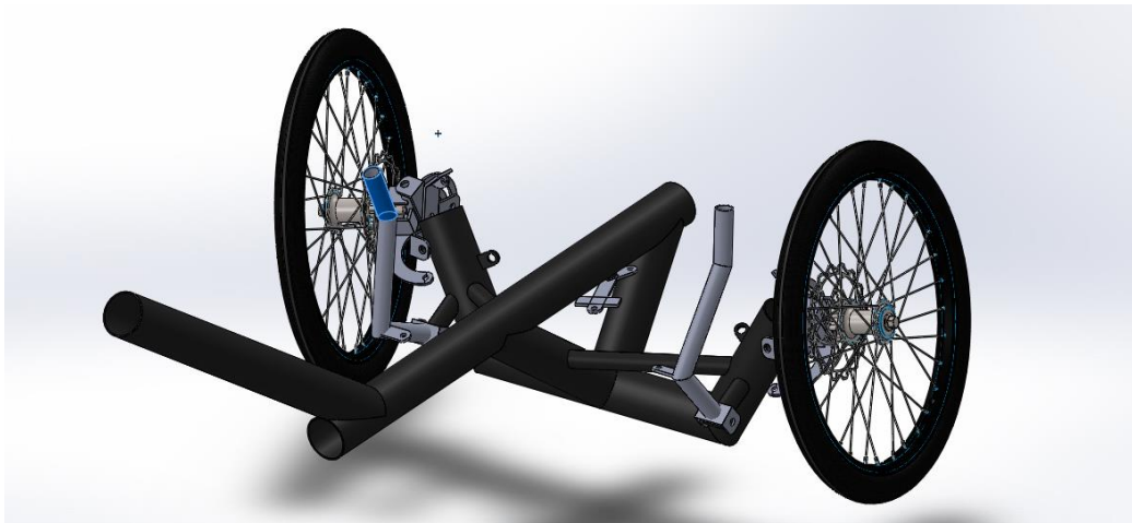
Kuva 13. Yksinkertaistettu runko ja ohjauslaitteisto, kääntö vasemmalle
