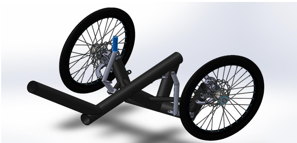
Kuva 14. Yksinkertaistettu runko ja ohjauslaitteisto, kääntö oikealle
