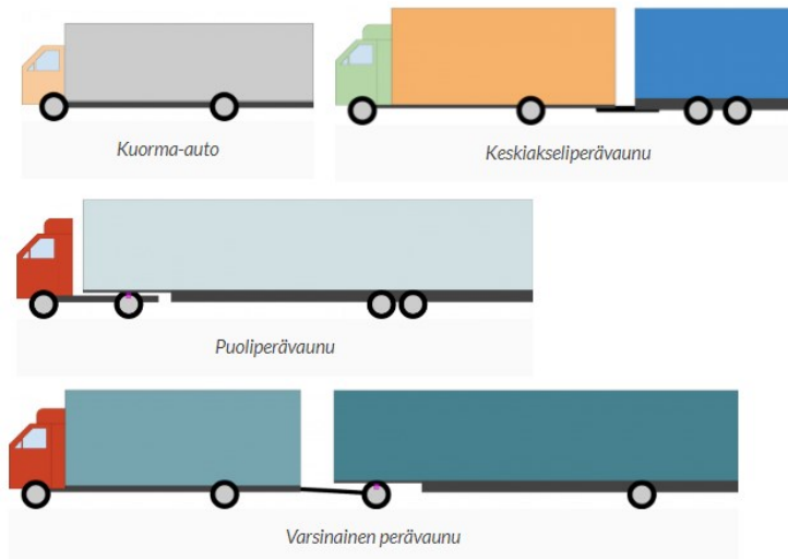
Kuva 3 Havainnepiirroksia kuorma-autoista ja yhdistelmäajoneuvoista [11].
