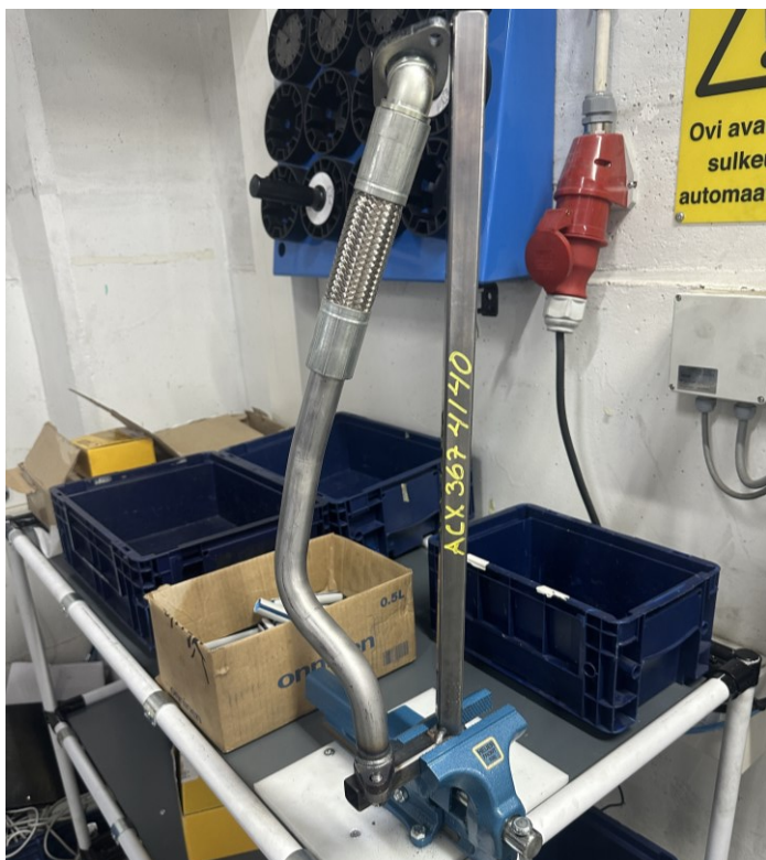
KUVA 14. Liitoksen suunnan asettaminen jigissä.
