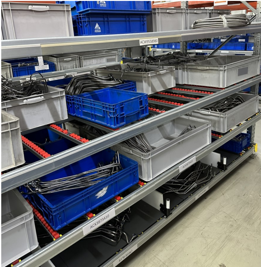
KUVA 33. Yksi putkiosastolla käytössä olevista läpivirtaushyllyistä.
