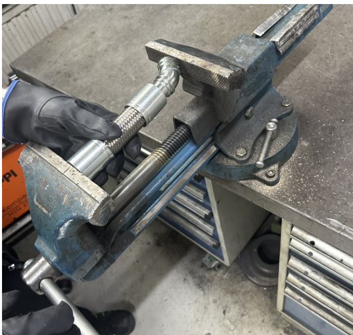
KUVA 12. Adapteriliittimen työntäminen teräspunosletkun sisään.
