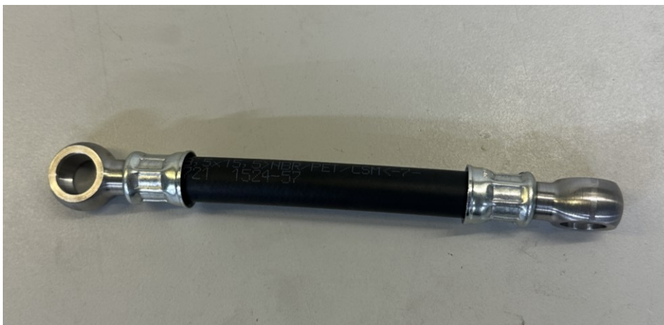
KUVA 24. Polttoaineen esisuodattimen letku.
