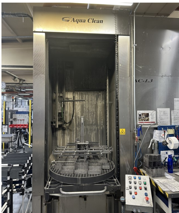
KUVA 4. Aqua Clean AC-1.3 -osienpesukone.
