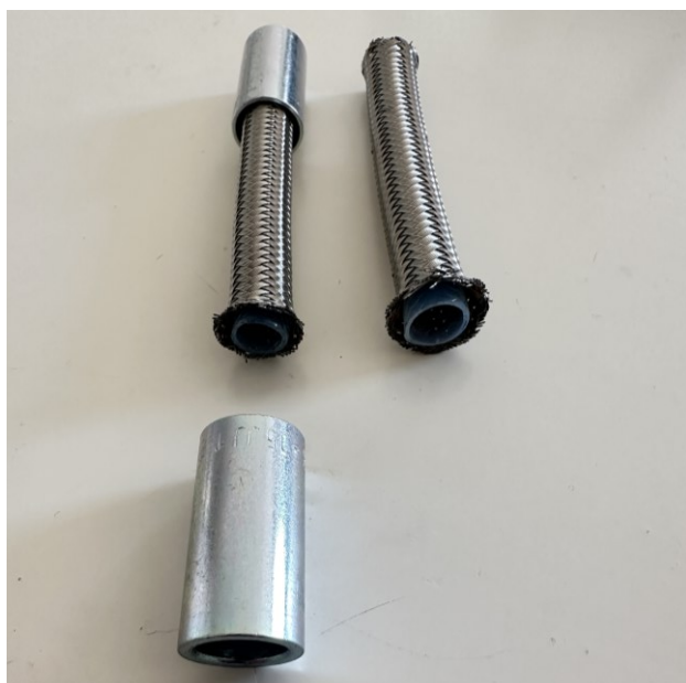
KUVA 26. Katkaisussa rispaantunut teräspunosletku.
