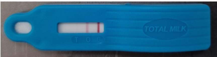
Kuva 32. Muovi- ja alumiinipinnan liitoskohdan negatiivinen tulos allergeenitestillä (Samppala, 2023).
