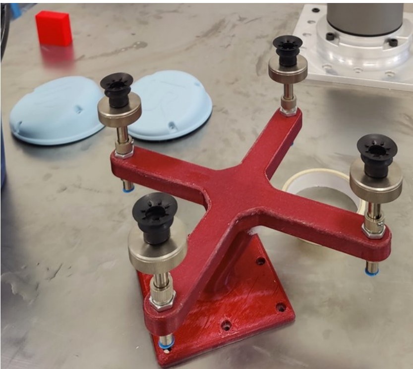
Kuva 13. 3D-tulostettu päätetyökalu sekä palikka ja nivelsuojat (Samppala, 2023).
