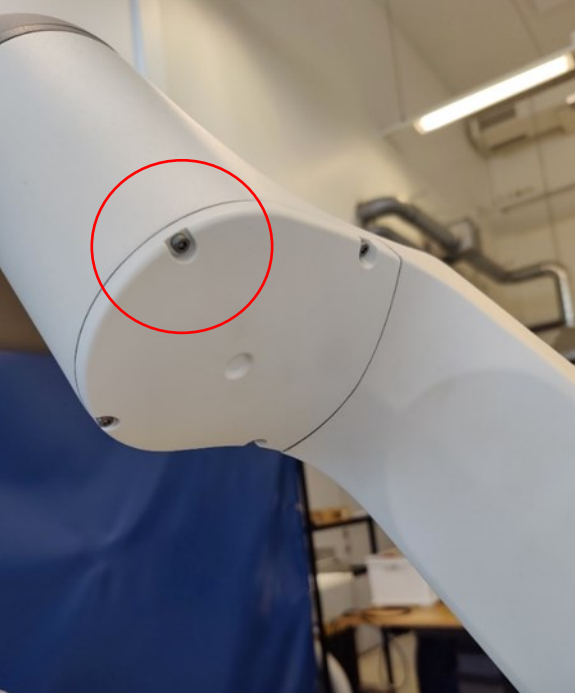
Kuva 22. GoFan ruuviliitoksia ja välejä eri kuvakulmasta (Samppala, 2023).
