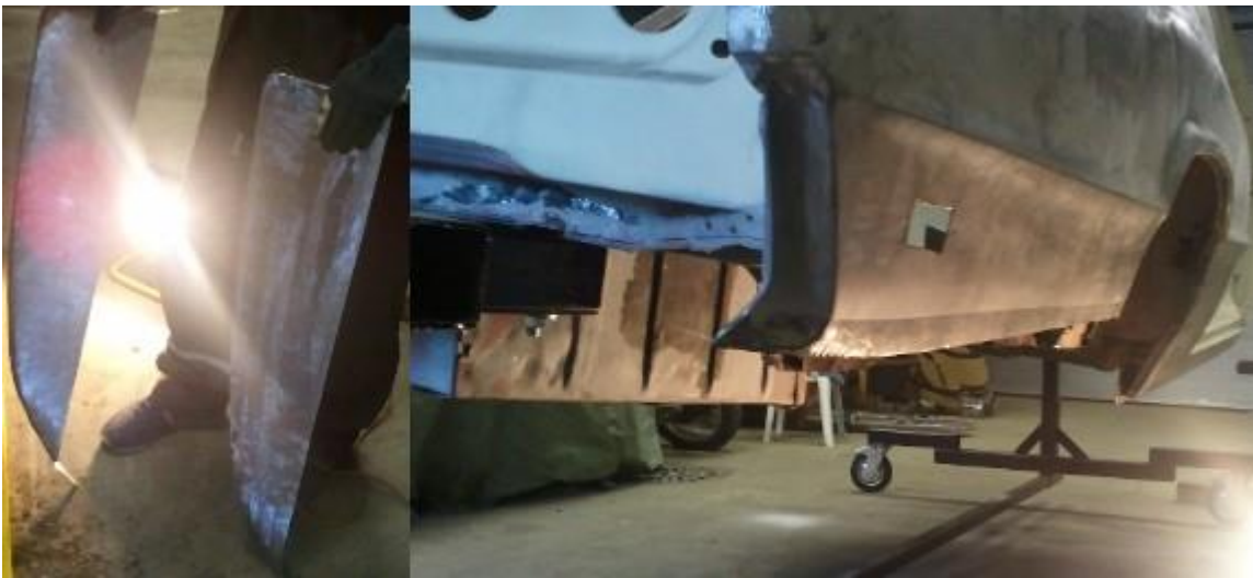
Kuva 65. Takaosan sivuhelman uudet alaosat ja pois leikattu alaosa (Kuvat: Olli Panhelainen).
