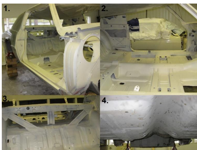
Kuvakollaasi 18. Puhalletun pinnan suojaus 1–4 (Kuva: Olli Panhelainen).
