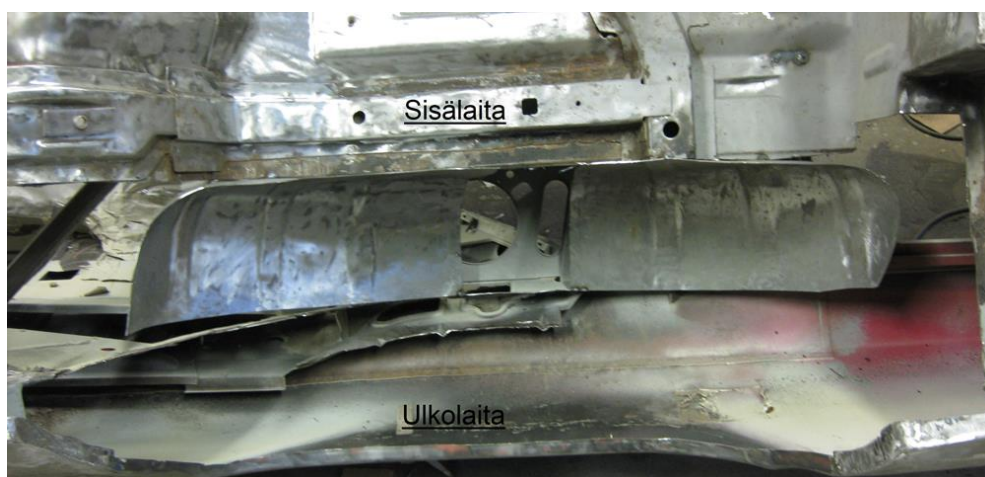
Kuva 73. Sisälaidan muotoilua (Kuva: Olli Panhelainen).
