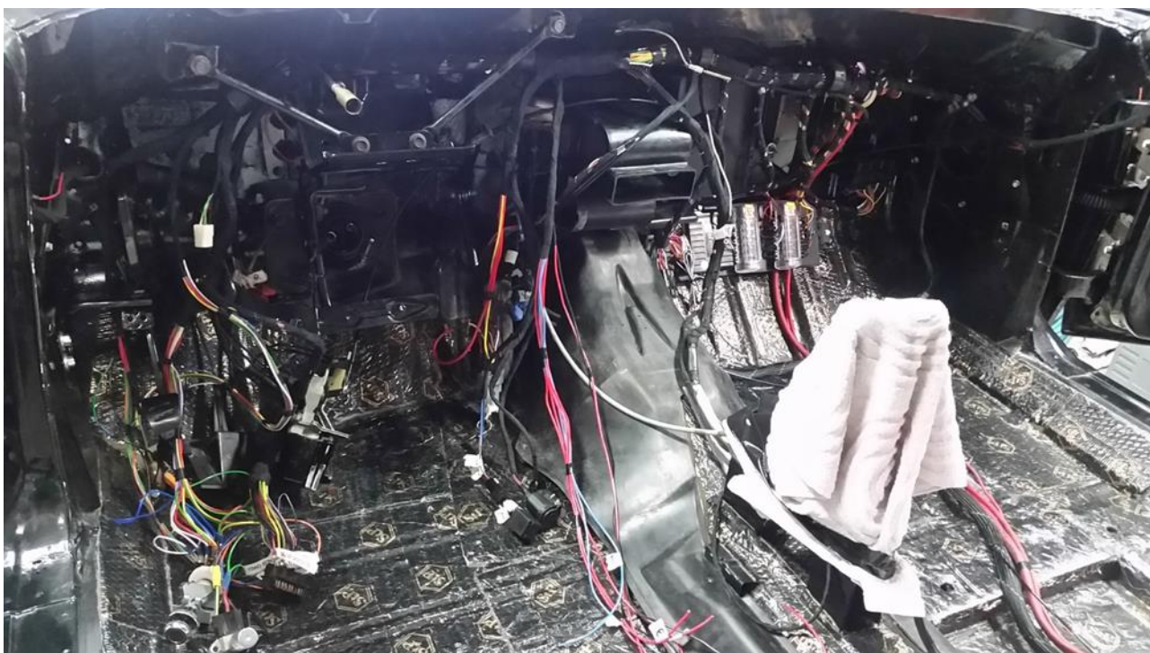
Kuva 116. Lopputilanne kojelaudan johtosarjat (Kuva: Olli Panhelainen).
