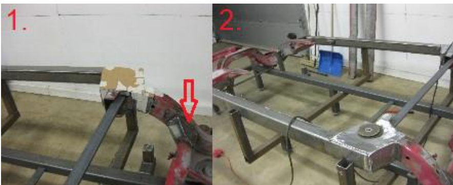
Kuva 43. Pahvimalleja, vahvistusta ja runko käännettynä (Kuvat: Olli Panhelainen).
