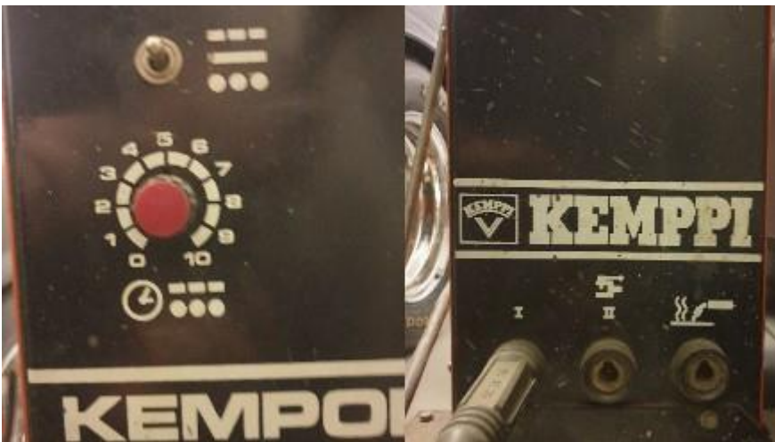
Kuva 23. (vasen) hitsaustapa ja ajastin valinta, (oikea) lämpöoikaisuliitintä 3 oikealla (Kuvat: Olli Panhelainen).
