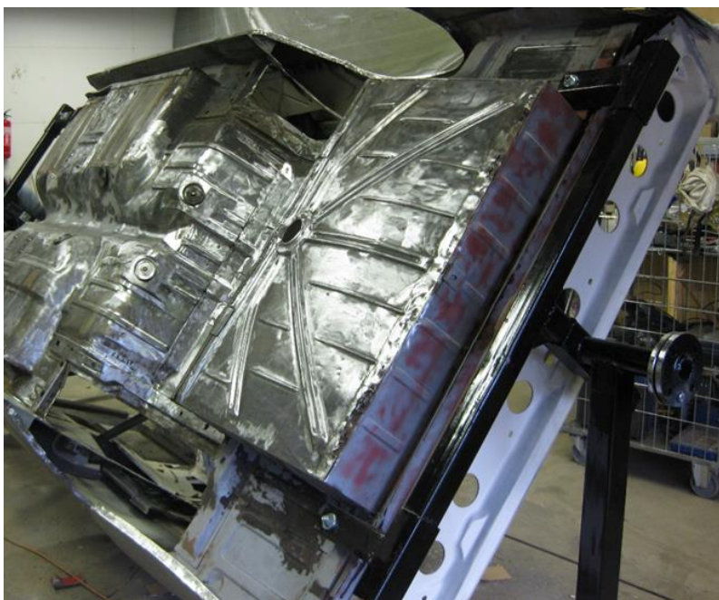
Kuva 72. Sisälokasuojat poistettuna (Kuva: Olli Panhelainen).
