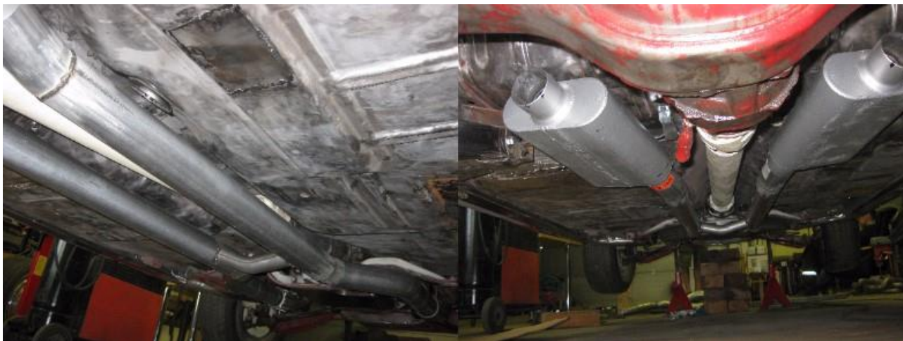
Kuva 81. Putkiston keskiosa sekä äänenvaimentimet (Kuvat: Olli Panhelainen).
