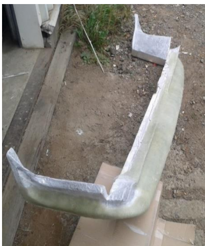
Kuva 89. Lasikuitumuotti (Kuva: Olli Panhelainen).
