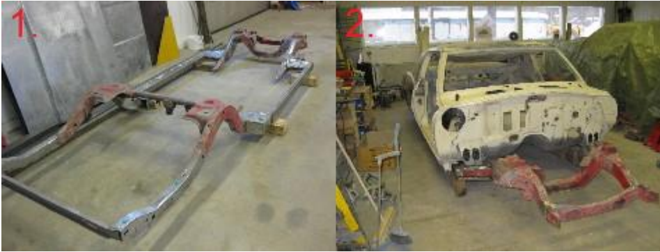
Kuva 44. Valmis runko sekä korin sovitus rungolle (Kuvat: Olli Panhelainen).
