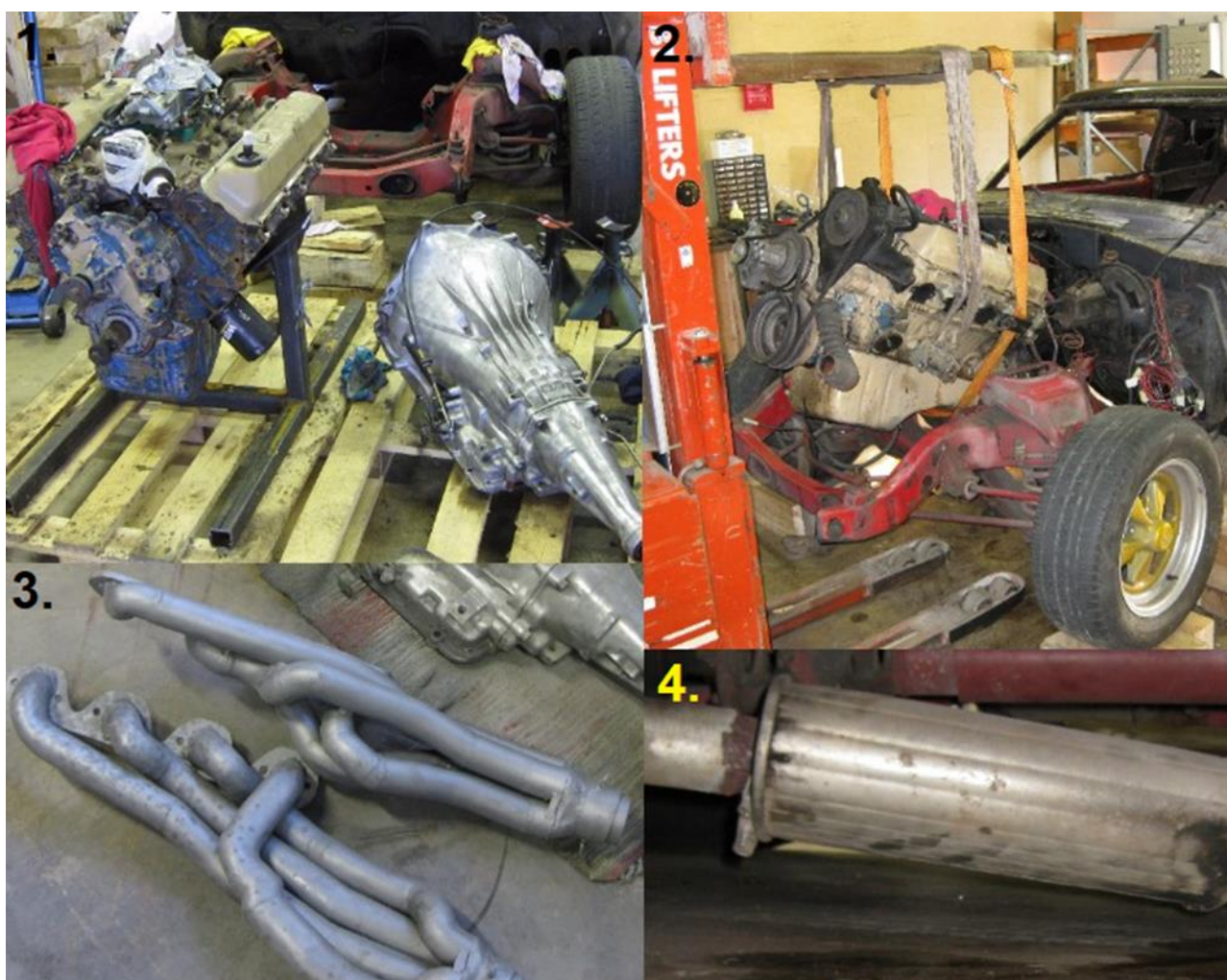
Kuvakollaasi 16. Moottorin ja vaihdelaatikon irrotus sekä putkiston purkaminen 1–4 (O. P)
