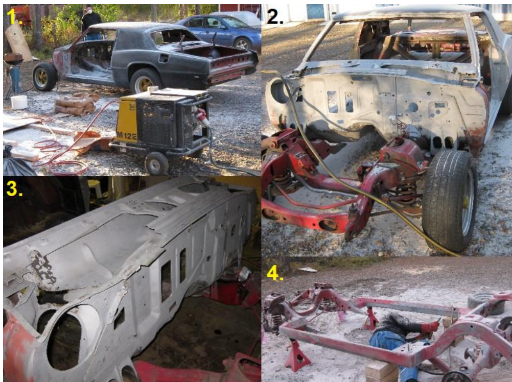
Kuvakollaasi 17. Hiekkapuhallus kori, runko, osat 1–4 (Kuva: Olli Panhelainen).
