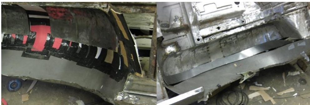
Kuva 74. Peltien tekoa ja silloittamista (Kuva: Olli Panhelainen).
