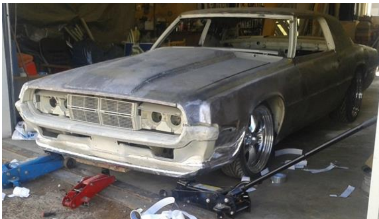
Kuva 88. Etuhelman mallin lopullinen muoto ja suojaus (Kuva: Olli Panhelainen).
