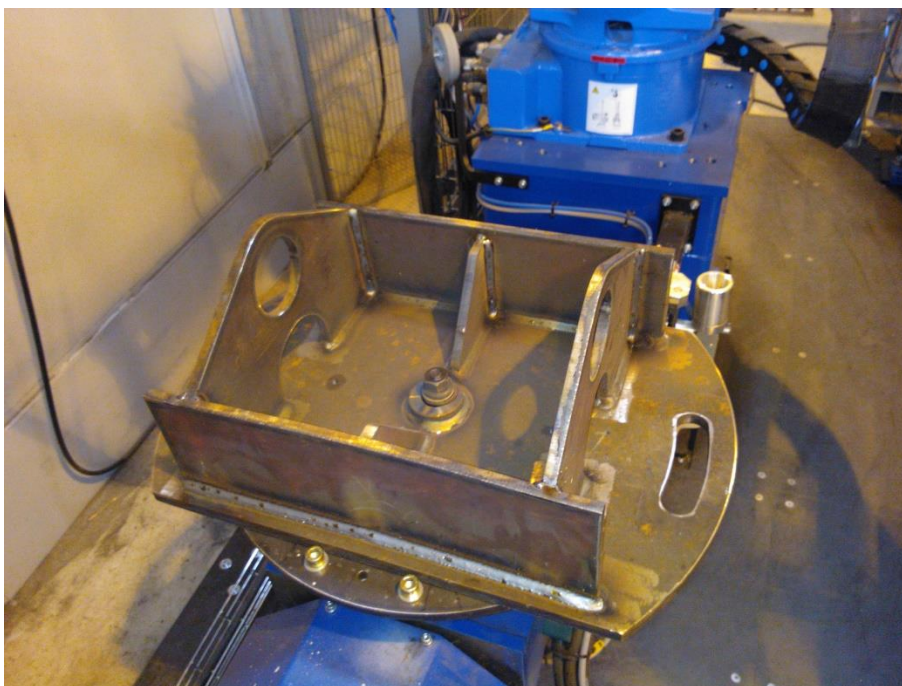
Kuva 20. Valmis työkappale kiinnitettynä ja hitsattuna
