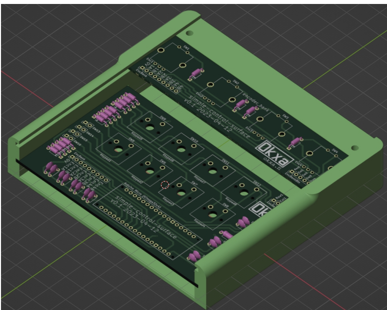
Kuvio 20: Laittekotelon alapuoli Blenderissä ja piirilevyjen kiinnitystapa.
