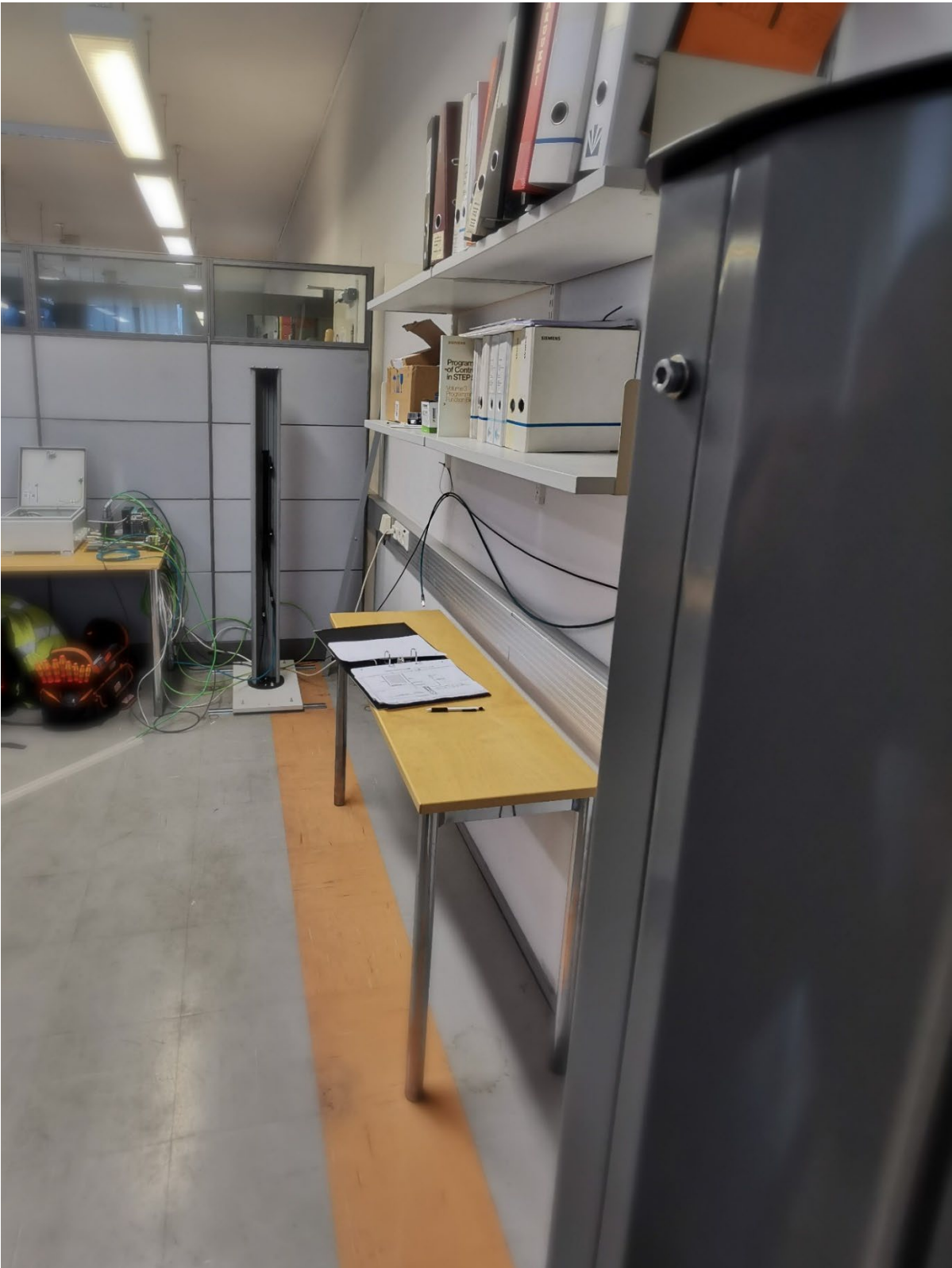
KUVA 11. Valoverhon mittausväli, jossa lähettävä yksikkö lähempänä kuvaajaa ja kytkentäkotelo, logiikkaprosessori ja virtalähde vastaanottavan yksikön vieressä
