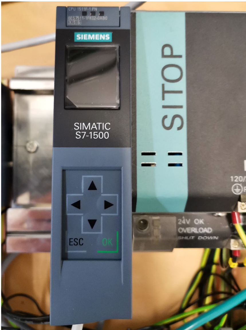
KUVA 12. Siemensin 1511f-1 pn logiikkaprosessori ja Sitop 24V DC/10 A virtalähde
