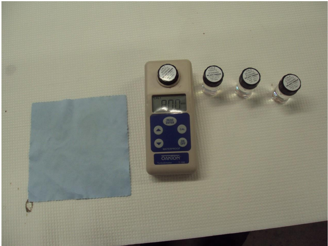
KUVA 6. Sameusmittari ja standardiliuokset (Niemelä 2014)
