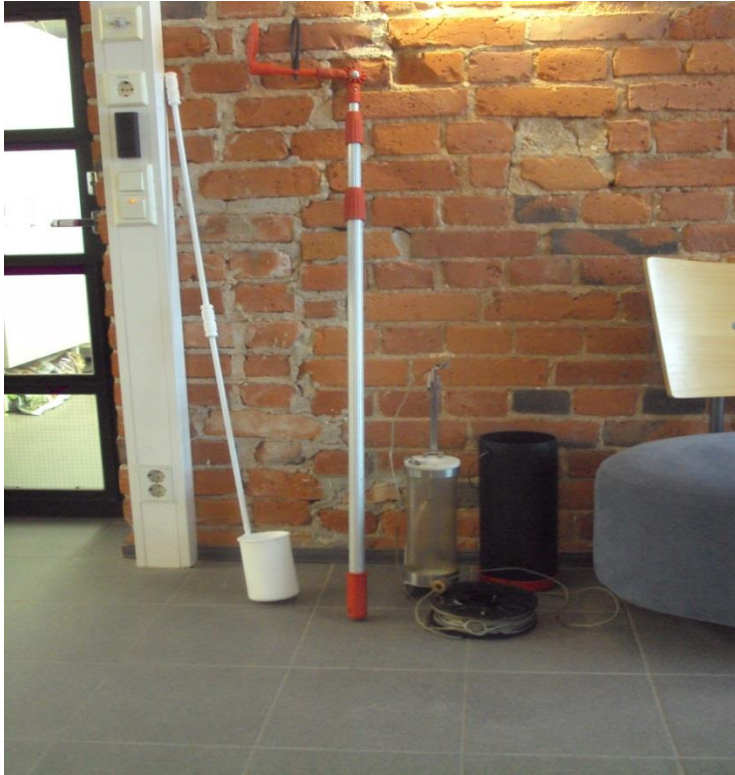
KUVA 4. Vasemmalla kaksi vesinäytteenotinta ja oikealla limnos (Niemelä 2014)
