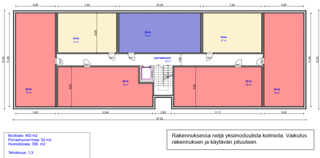
KUVA 3. Mallipohja, jossa käytetty neljää yhden moduulin kolmiota. Voidaan huomata vaikutukset rakennuksen pituuteen ja kapeaan muotoon
