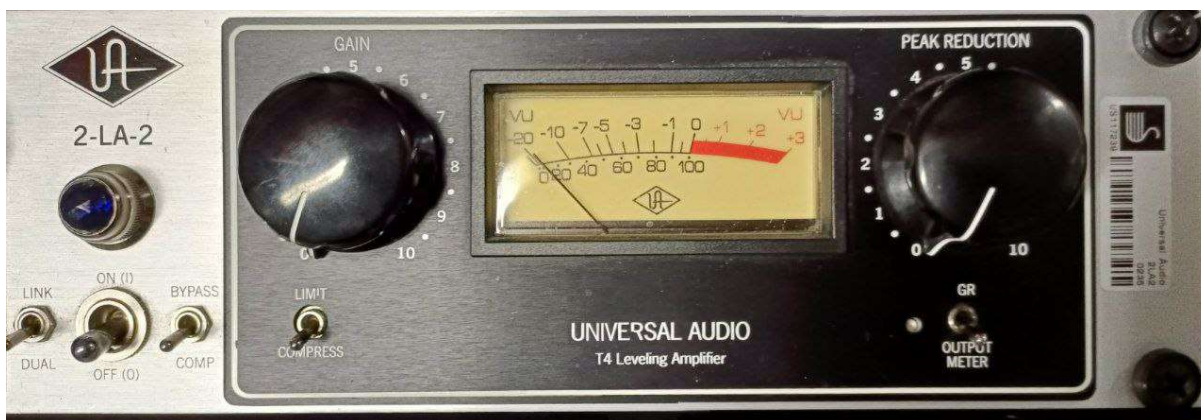
Kuva 6. Kuva yhdestä Universal Audion valmistamasta 2-LA-2 Stereokompressorin yksiköstä. (Universal Audio)
