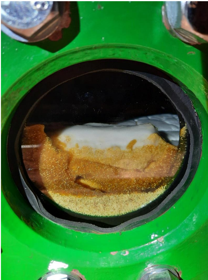
Kuva 3. Sarjan 2 kationinvaihtimeen muodostunutta kipsiä.
