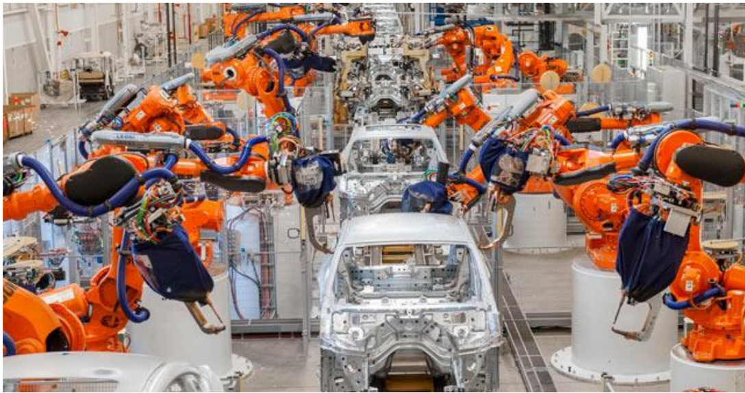
Kuvio 17. Autotehtaan korihitsauslinjan kiertyvänivelrobotteja (Haophuong21, 2021)
