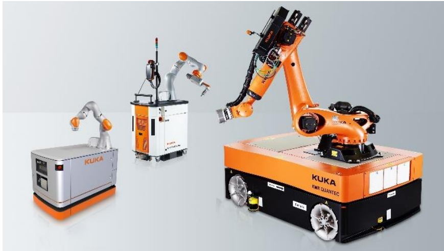
Kuvio 20. Kiertyvänivelrobotteja asennettuna erilaisille (AMR) mobiilirobottialustoille (KUKA AG, 2020)
