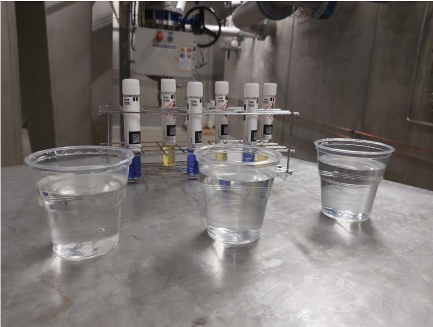
Kuvio 9. TOC- ja COD- spektrofotometriputket sekä vesinäytteet (raakavesi, hiekkasuodatettu vesi ja aktiivihiilisuodatettu vesi).
