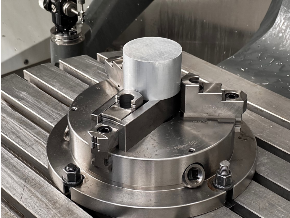
Kuva 45. Aihio kiinni kolmipisteleuoissa.
