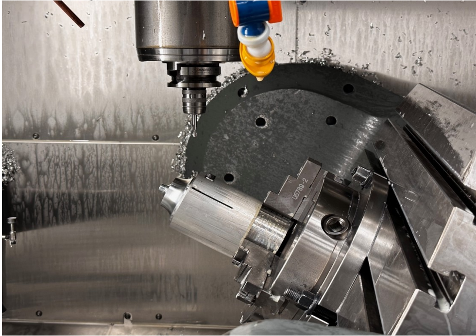
Kuva 7. Pöytä kallistettuna 5-akselisessa työstössä.
