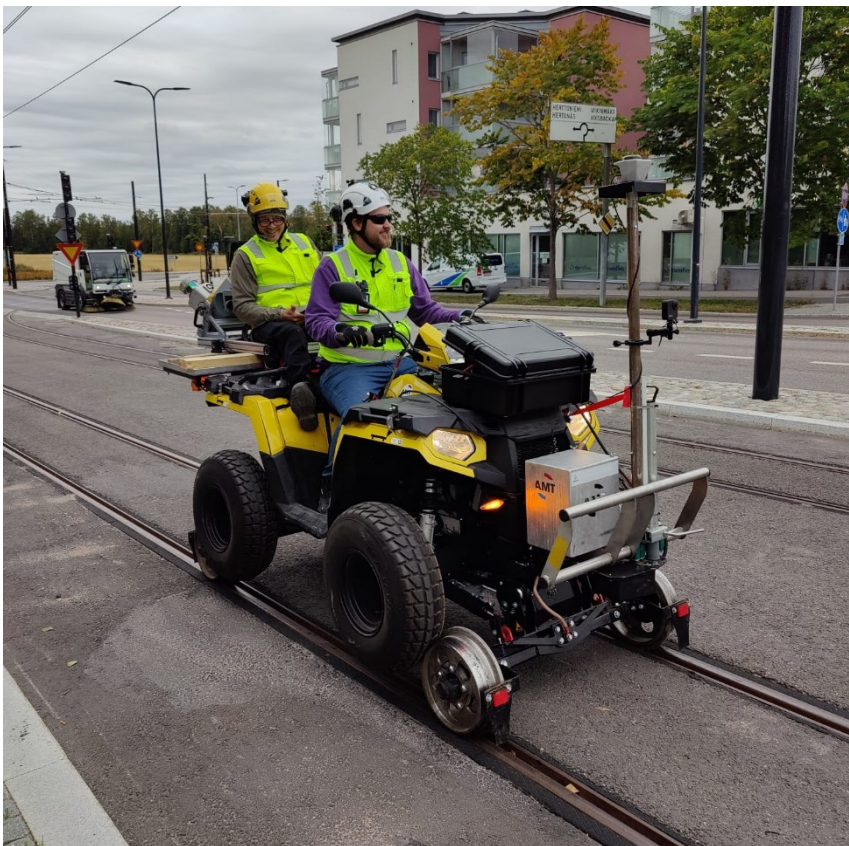
Kuva 18. Kiskopyörämönkijä ja Tribler MX9 -mobiililaserkeilain.
