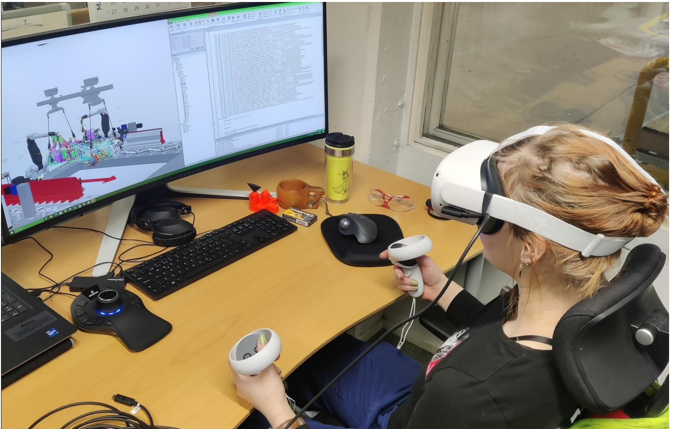
Kuvio 13 Valtran maalausrobottien ohjelmointia virtuaalisesti Robot Studiolla
