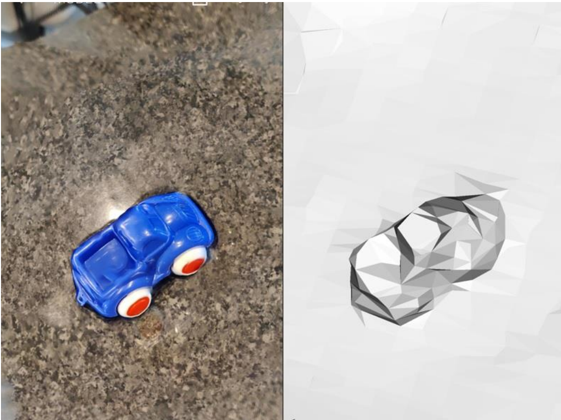
Kuvio 16 Fotogrammetrian muodostama 3D-malli leluautosta.
