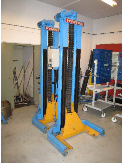
Kuva 7. Raskaan kaluston nostinpilarit, joilla nostetaan ajoneuvoa renkaista. Nostimet ovat merkkiä Hywema RG 6,5/2 HD, joiden teknisiä tietoja on alla olevassa taulukossa.
