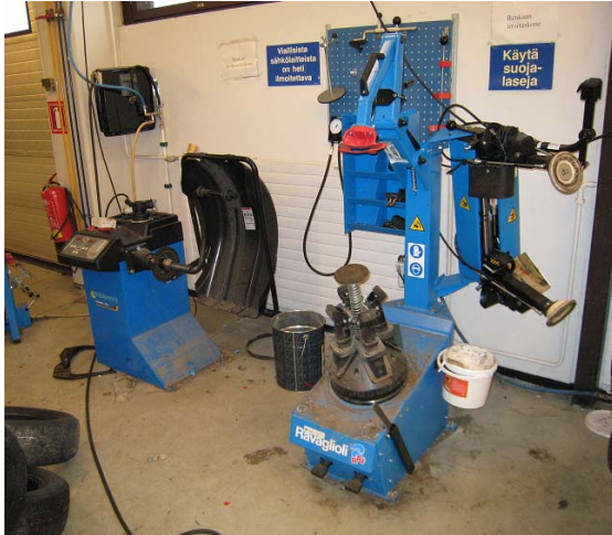
Kuva 10. Rengastyökeskus, jossa tasapainotus- ja rengaskone.
