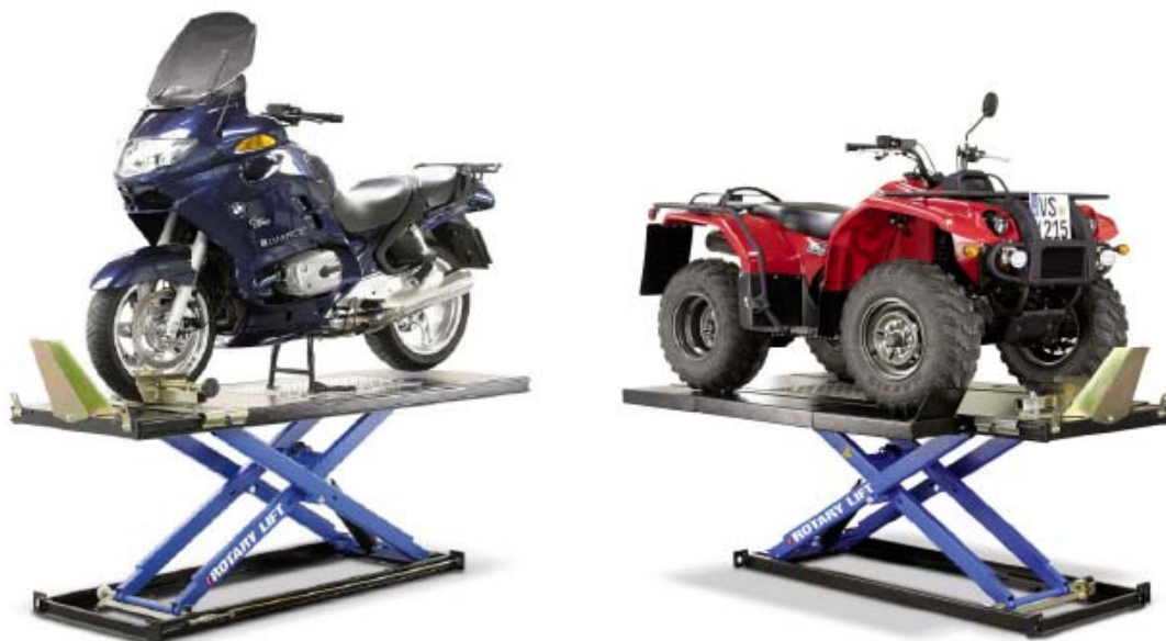
Kuva 8. Moottoripyöränostin Texo Sollevator MOTUS PSM05/S, joka on sähköhydraulinen nostin. Kuvassa lisävarusteena on mönkijälle levikesarja.
