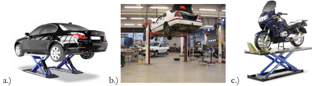
Kuva 6. Pienkonekorjaamon nostintyyppiä: a.) matala saksinostin, b.) kaksipilarinostin ja c.) moottoripyöränostin.
