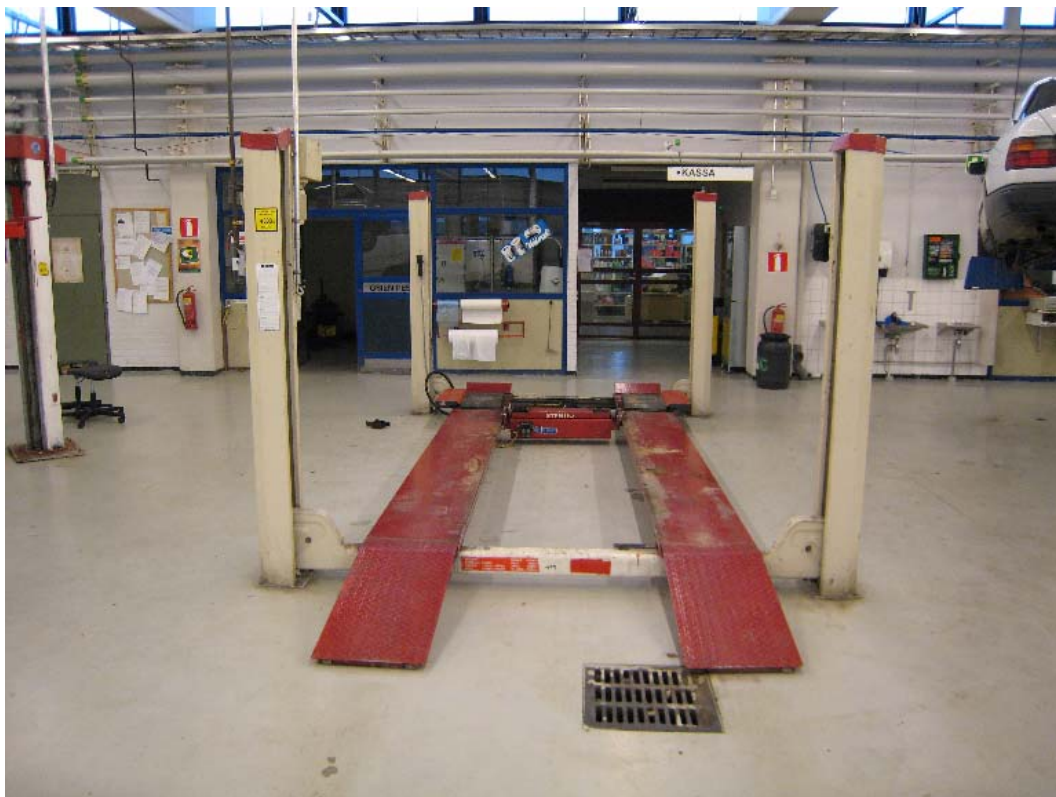
Kuva 1. Nelipilarinostin Stenhøj Major 400 -sarja, tekniset tiedot:
