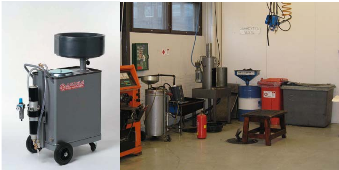
Kuva 9. Vasemmalla öljyn imuvaihtaja ja oikealla öljynkeräyspiste.
