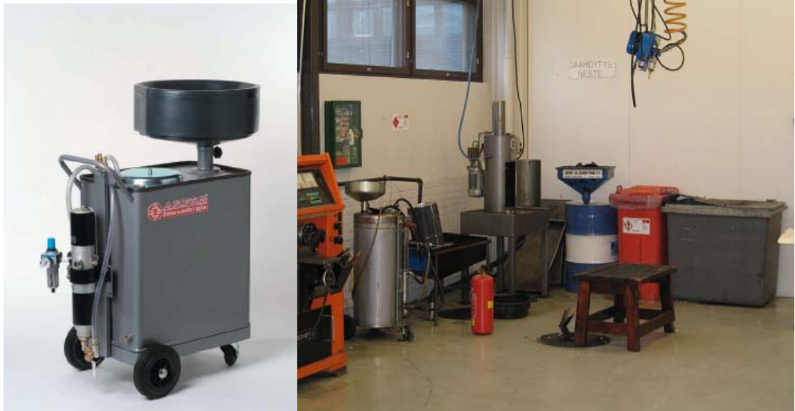
Kuva 10. Vasemmalla öljyn imuvaihtaja AR 421 ja oikealla öljynkeräyspiste.
