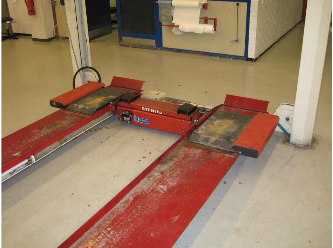
Kuva 9. Pyöränsiirtolevyt ja akselinkevennin on asennettuna 4-pilarinostin Stenhøj Major 400.
