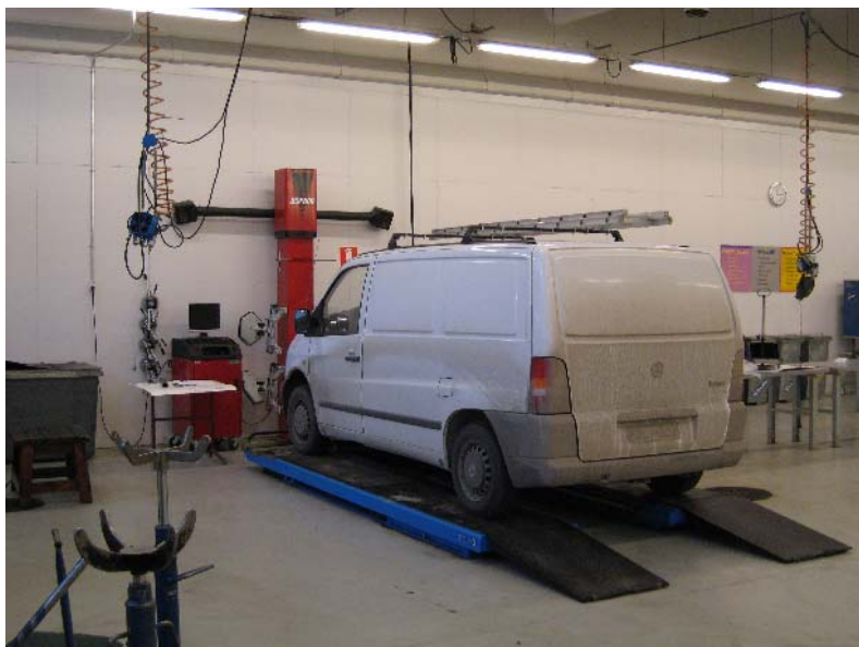
Kuva 6. Ajoneuvon pyöränsuuntauslaitteella on saksinostin Texa Sollevatori PSX4.
