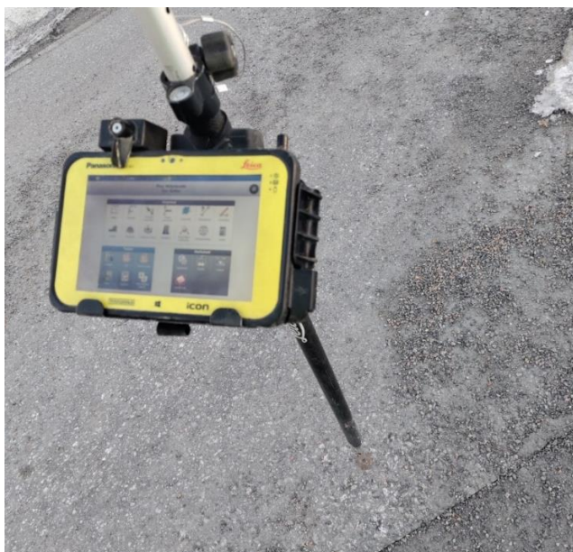
Kuva 18. RTK-GNSS-laitteen tarkistus Jyväskylän kaupungin kiintopisteelle
