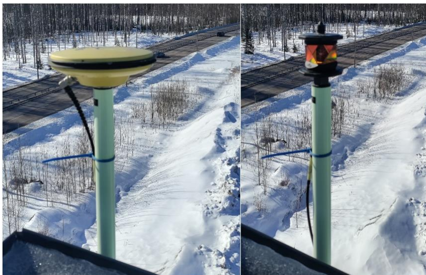
Kuva 16. Tukiaseman tarkistuksessa antennin paikalle kiinnitetään prisma mittauksen ajaksi.
