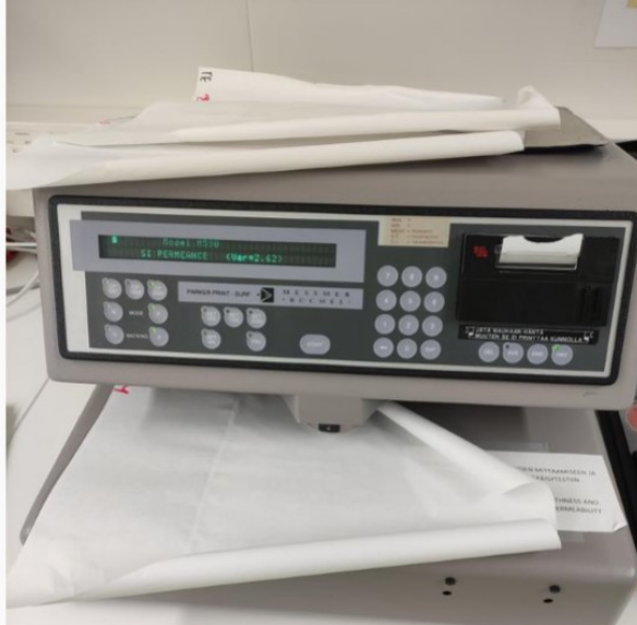
KUVA 7. Pinnan ilmanläpäisevyyden sekä sileyden mittari.
