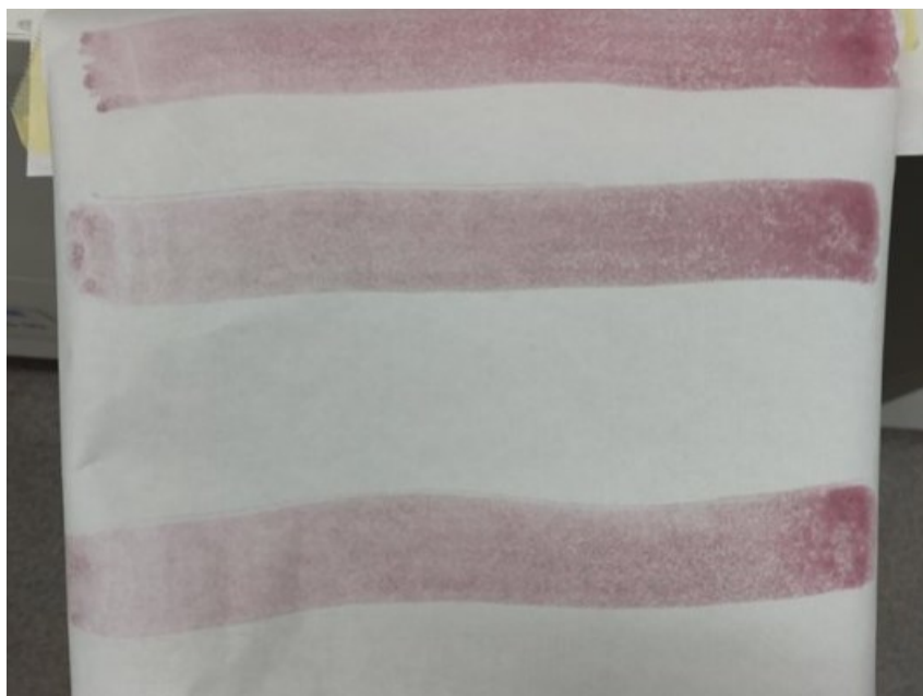
KUVA 14. Pinholes -testin tulos
