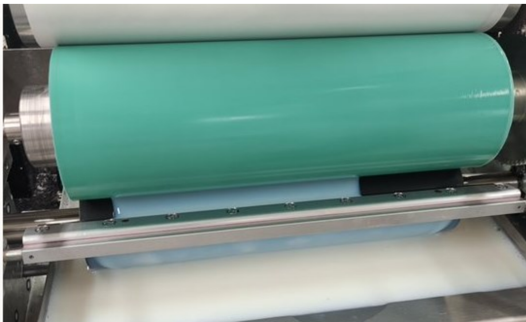
KUVA 13. Päälysteaine on noussut kaavaimen päälle.
