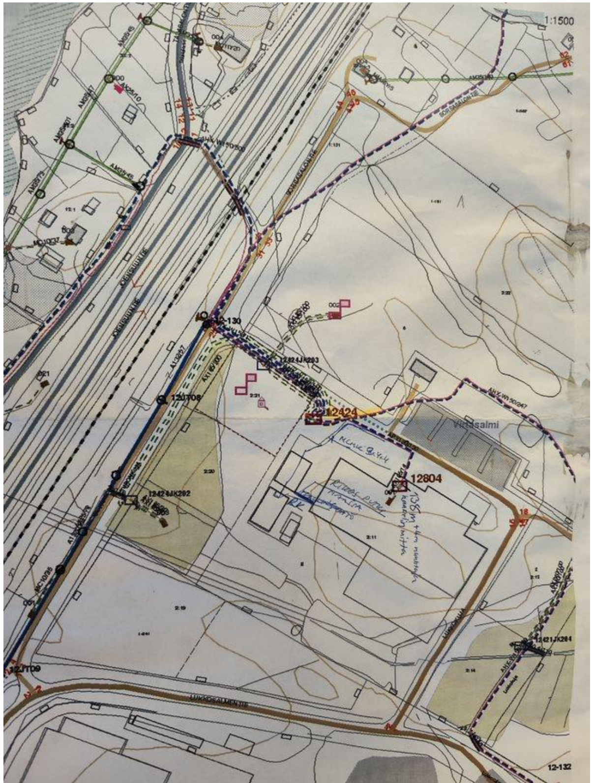
KUVA 15. Trimble NIS kuvankaappaus Scantarpin läheisestä muuntajasta ja johto-osuudesta (Tirkkonen, 2023)
