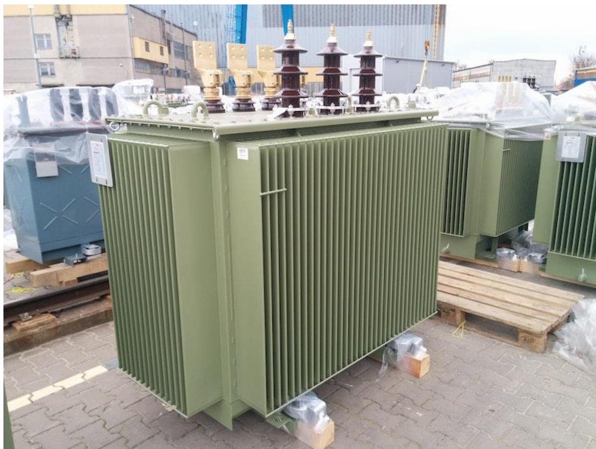
KUVA 12. ABB- jakelumuuntaja. (Onninen Oy, 2023)
