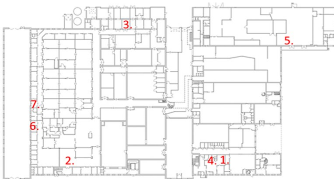
Kuva 6. Kuvassa ensimmäisen kerroksen sähkökeskukset kulutusmittauksiin.
