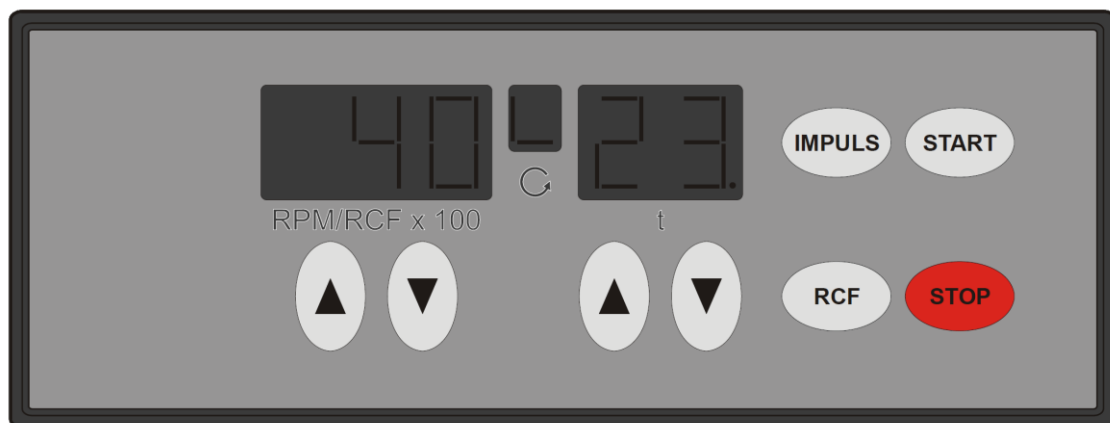
KUVA 3. Sytosentrifugin ohjauspaneeli (THARMAC 2017).
