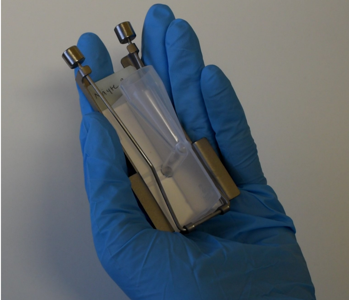
KUVA 5. Valmis Cellfunnel -näytekelkka (Kuva: Jouni Mäki-Runsas, 2023 ©).
