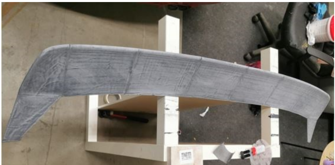
Kuva 8. 3D-tuloste hiottuna yhden polyesterimaalikerroksen jälkeen.
