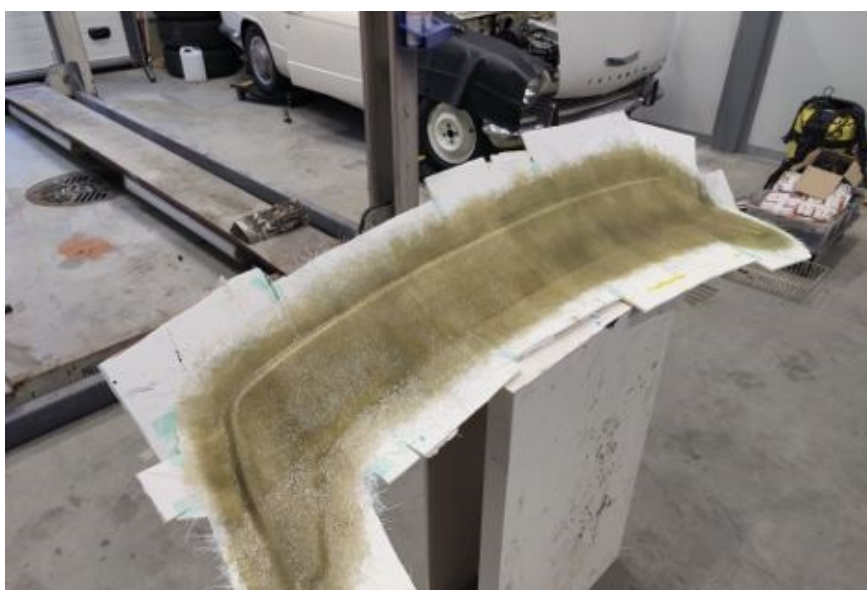
Kuva 12. Spoilerin yläpuoli laminoituna lasikuidulla.
