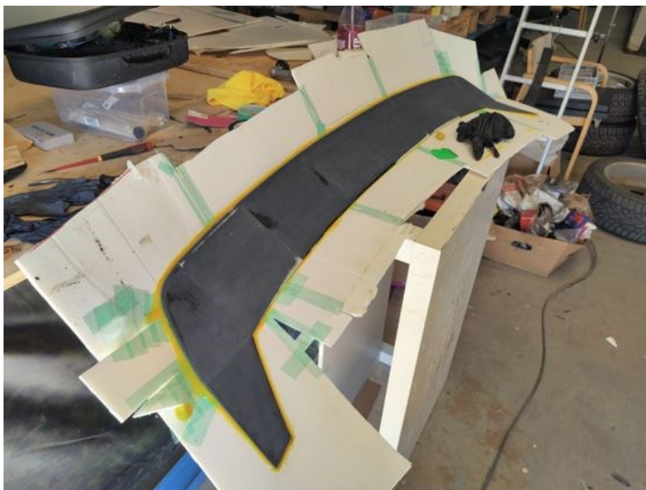
Kuva 9. Polypropeenikennolevyt liimattuna sekä vaha levitettynä.
