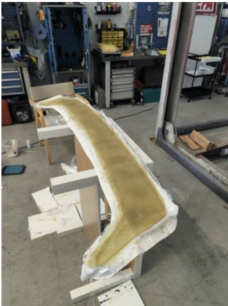
Kuva 16. Muotti laminoituna lasikuidulla.
