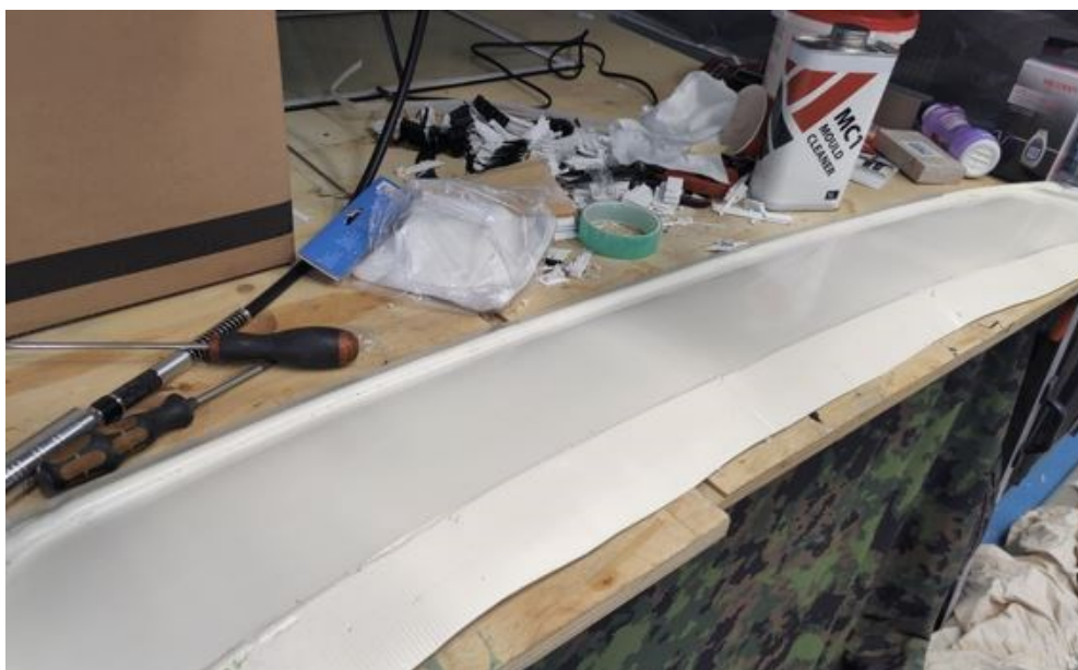
Kuva 15. Muotin pinta puhdistettuna.
