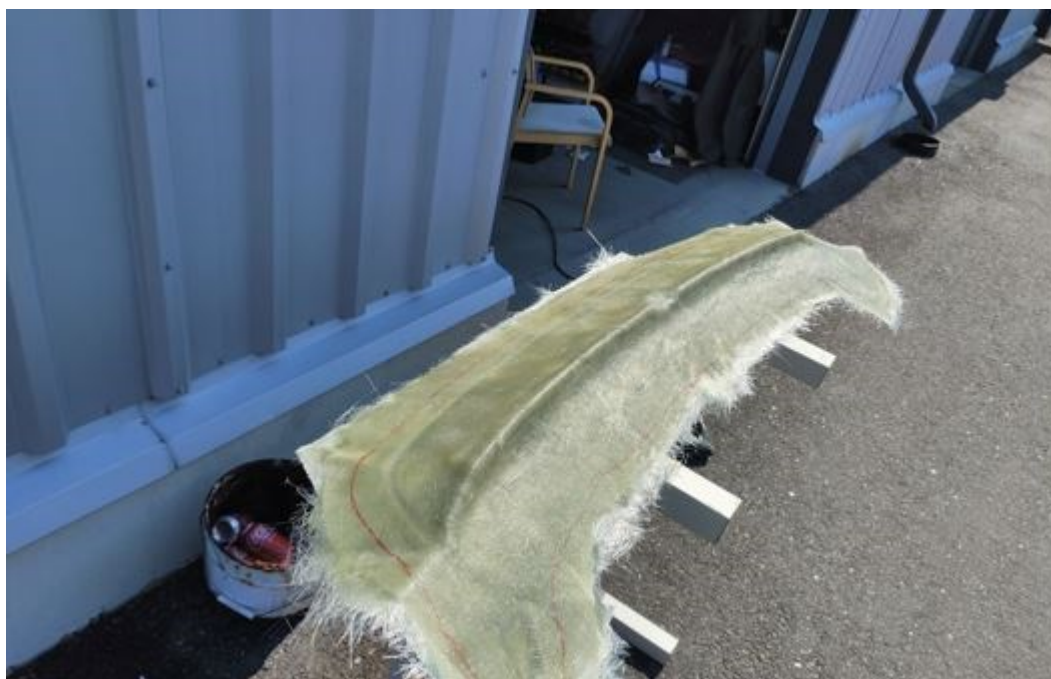
Kuva 13. Kappale laminoituna ja leikkausviiva piirrettynä.
