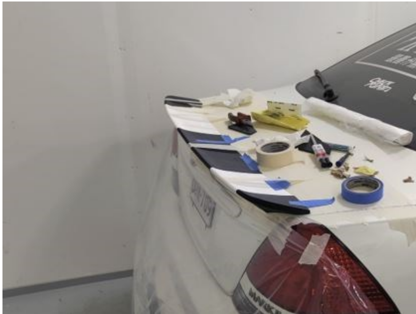
Kuva 7. Tulosteen kokoaminen tavaratilan kantta vasten.
