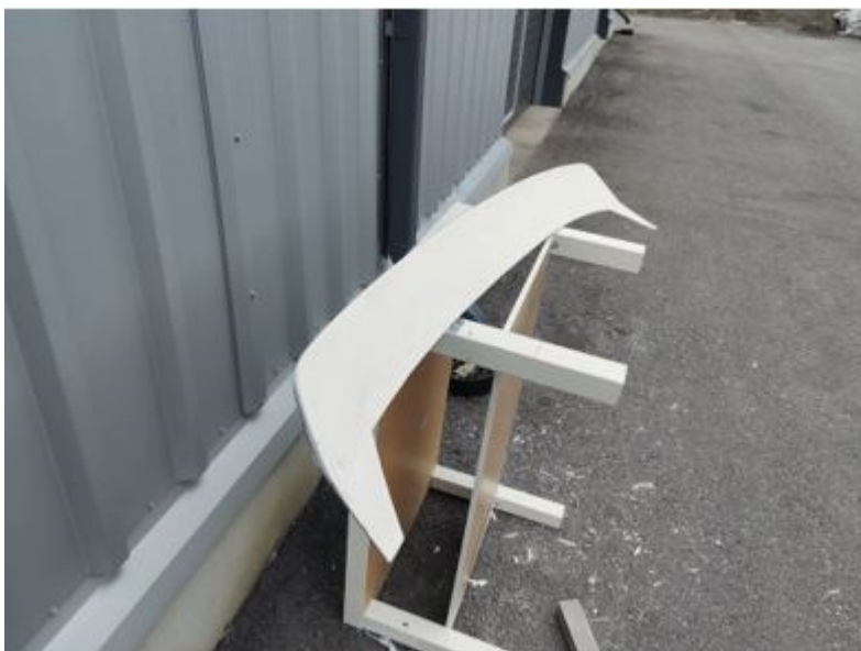
Kuva 18. Spoileri liimattuna kokoon ja liitospinnat hiottuna.
