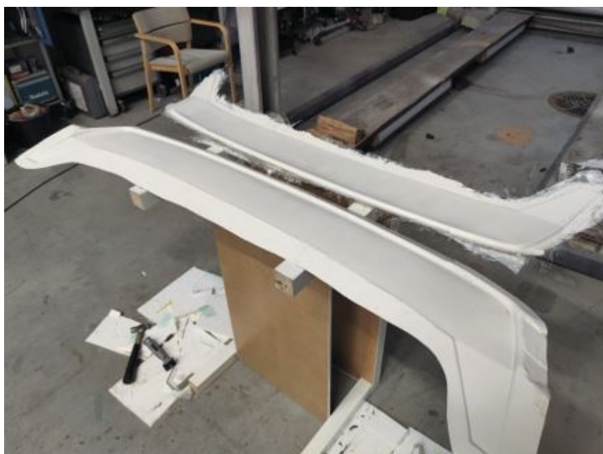
Kuva 17. Spoilerin yläpuoli irrotettuna muotista.
