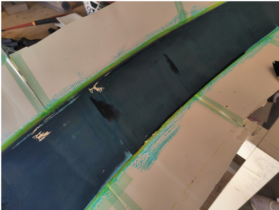
Kuva 10. PVA-irrotusaine levitettynä spoilerin päälle.
