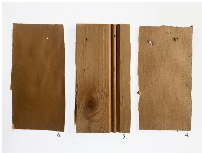
Kuva 26. Seinäpinnan näytteet 4.–6. joista uusin on näyte 4. kuvan oikeassa reunassa.
