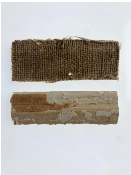
Kuva 31. Kangaskaton kerrokset ovat kuvassa esitetty nurjalta puolelta.
