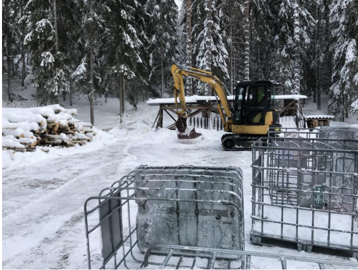
Figur 4. Komatsu PC 50 med truckgafflar, skopor och en grip används mest för att flytta fulla häckar och säckar men också för att lyfta större stockar till klabbmaskinens matningsbord samt för lastning. (Bild Henrik Niskanen).
