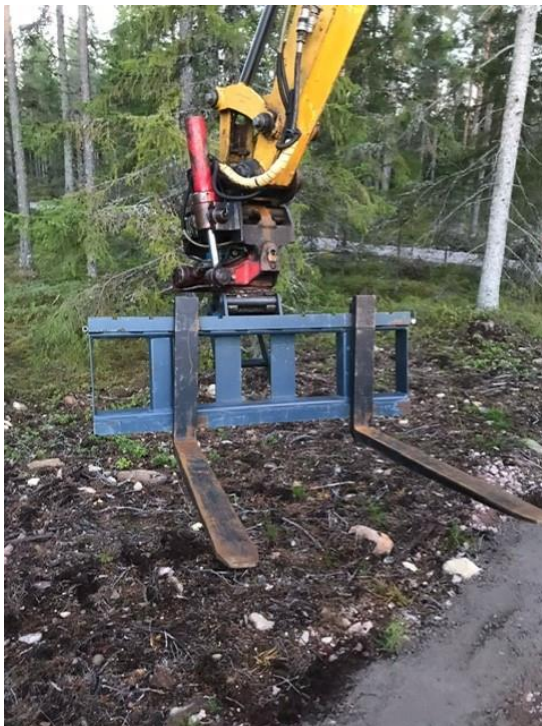
Figur 5. Truckgafflar monterade på grävmaskinen. (Bild Henrik Niskanen).
