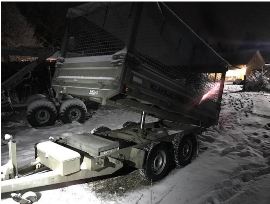
Figur 2. Ett exempel på tippkärna avsedd för transport av brännved. På marknaden finns det olika modeller och storlekar. (Bild Henrik Niskanen).
