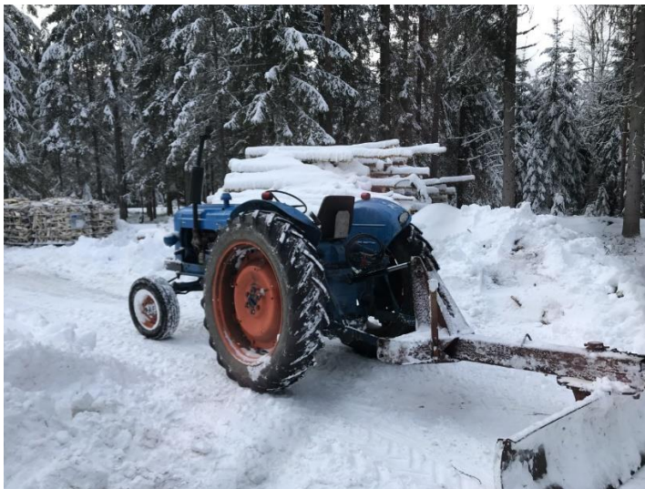
Figur 3. Fordson Major med truckgafflar, en snöplog och ett släp. Används mest som en kraftkälla för klabbmaskinen men också för transport av brännved och för snöarbete på sågningsområde. (Bild Henrik Niskanen).
