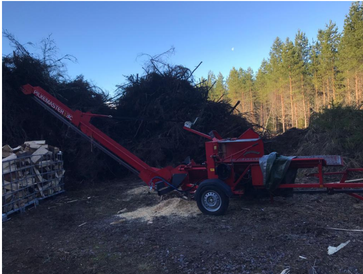
Figur 8. Klabbmaskin som är flyttbar. Vikten är 750 kg så maskinen kan dras med personbil. (Bild Henrik Niskanen).
