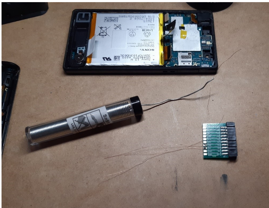
Kuva 48 Hyppylankojen kiinni juotto JTAG-adaptteriin
