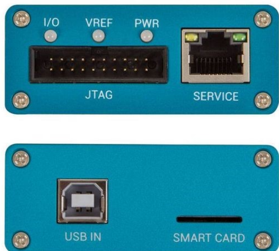
Kuva 14 Flasher boxin tyypilliset piirteet (GSMServer, 2017)
