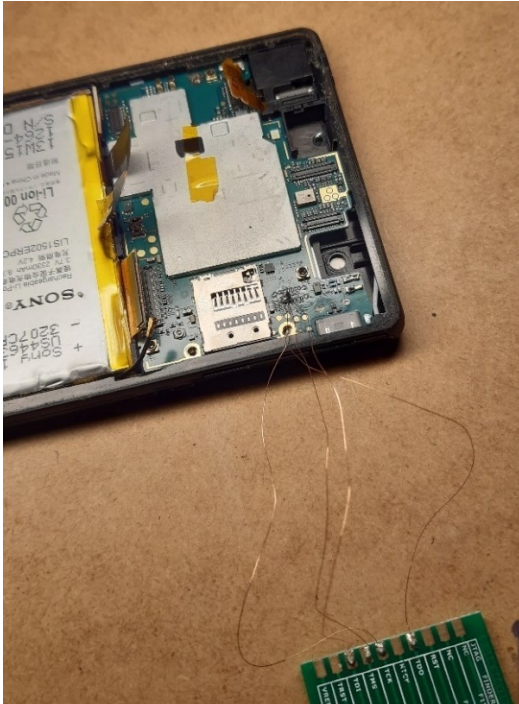
Kuva 51 Hyppylangat on juotettu
