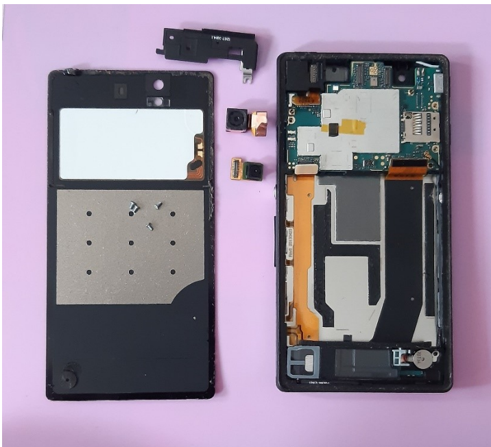
Kuva 44 Xperia Z helposti louhintaa häiritsevien osien irrottaminen
