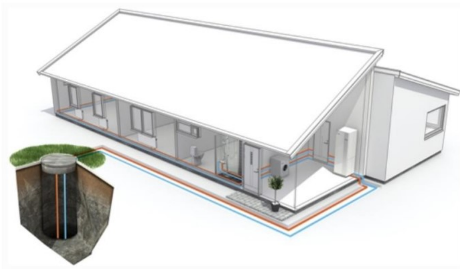
Kuva 3 Energiakaivon toimintaperiaate (Virkalevo, 2018)
