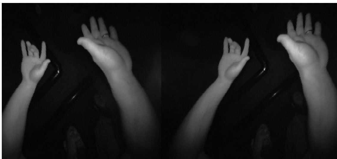
Kuva 9. Näkymä Ultraleapin moduulin kahdesta kamerasta [27].
