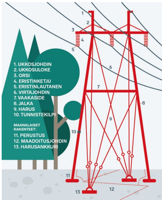
Kuvio 2. Harustetun pylvään rakenne (Voimajohdot 2022.)
