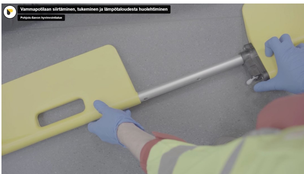
Kuva 9. Kuvakaappaus koulutusvideosta. Kauhapaarien pituuden säätäminen (Partanen 2023, CC BY-SA)
