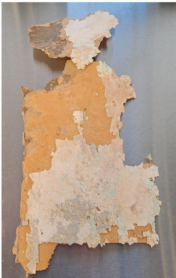
Kuva 16. Huoneen 102 näyte takaa ennen irrotusta. Päällimmäisessä tapetissa takana näkyy alemman tummia kuvioita
