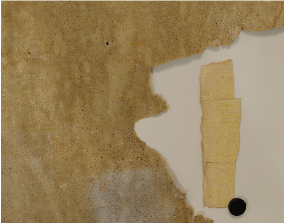
Kuva 37. Tapetin pinnoite ja värit ovat pahasti kärsineet. Pienissä paloissa on kuitenkin säilynyt alkuperäistä väritystä ja pinnoitteen kiiltoa.
