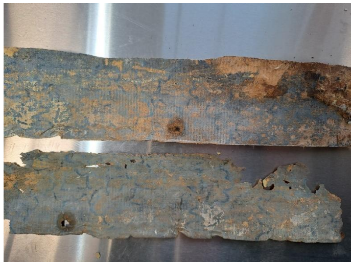
Kuva 13. laboratoriossa sisustuspahvista (yllä) irrotettu tapettinäyte (alla).
